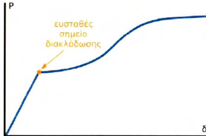
Εικόνα 98: Τυπικός δρόμος ισορροπίας φορέα που αστοχεί μέσω ευσταθούς σημείου διακλάδωσης
