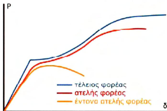
Εικόνα 105: Επιρροή αρχικών ατελειών σε φορέα που αστοχεί μέσω ευσταθούς σημείου διακλάδωσης
