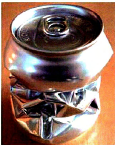
Εικόνα 65: Κουτί αναψυκτικού που έχει υποστεί ανελαστικό λυγισμό
