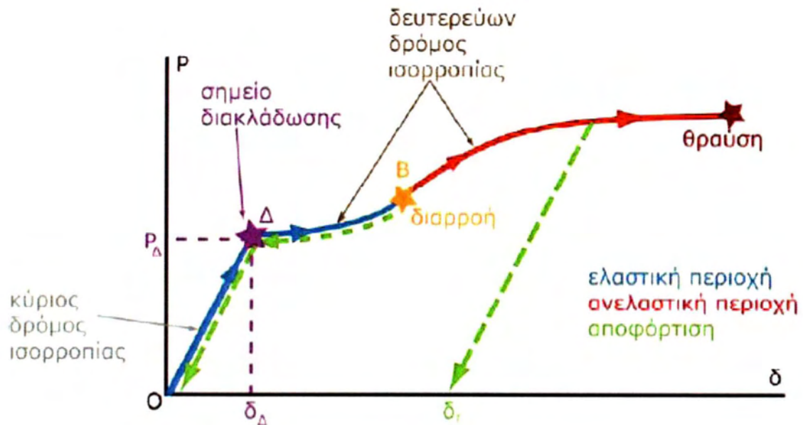
Εικόνα 62: Δρόμος ισορροπίας μακρού κυλίνδρου με παχιά τοιχώματα
