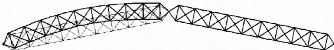
Εικόνα 91: Αστοχία δικτυωτής αψίδας λόγω ελαστικού λυγισμού ενός σκέλους
