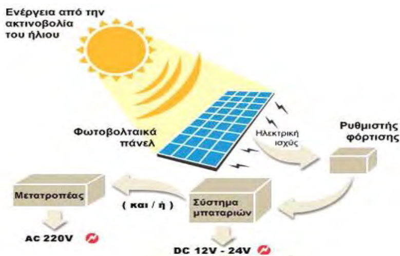
Εικόνα 4 Βήματα αποθήκευσης της ενέργειας στις μπαταρίες
