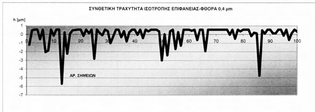
Σχήμα 4.6: Χαρακτηριστικό παράδειγμα κατατομών επιφάνειας κυλίνδρου MEK σε κατάσταση μετά το στρώσιμο (βιβλιογραφία)- και συνθετική τραχύτητα (προσομοίωση).
