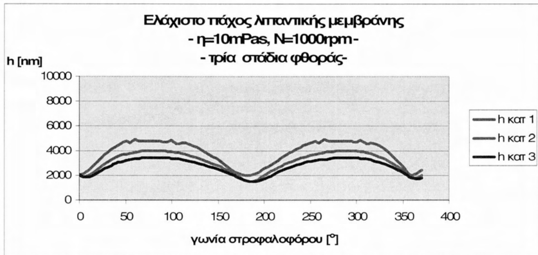
Σχήμα 4.1: Διάγραμμα h_{\min} = f(\beta) για τρία στάδια φθοράς κατατομής δακτυλίου – τραχύτητας κυλίνδρου N= 1000\text{rpm} , ονομαστικές συνθήκες.
