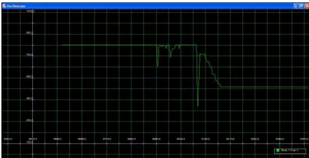
Εικόνα 34 – Μεταβολές στην κυματομορφή εξόδου του HMC1002 καθώς τον μετακινούμε στο χώρο.
