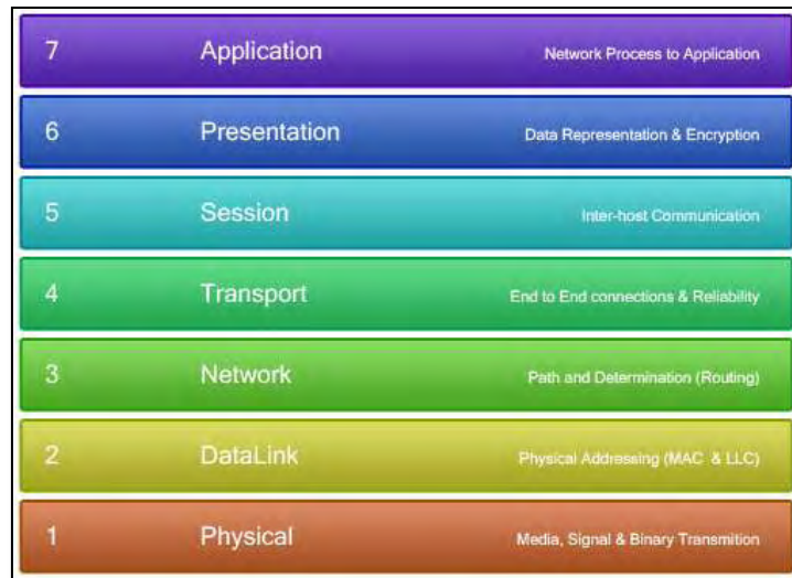
Εικόνα 3 –Τα επίπεδα του μοντέλου αναφοράς Ανοικτής Διασύνδεσης Συστημάτων
