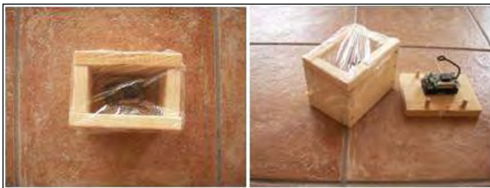
Εικόνα 30 – Ιδίόχειρη κατασκευή περιορισμού του εύρους του κώνου του NaPiO9
