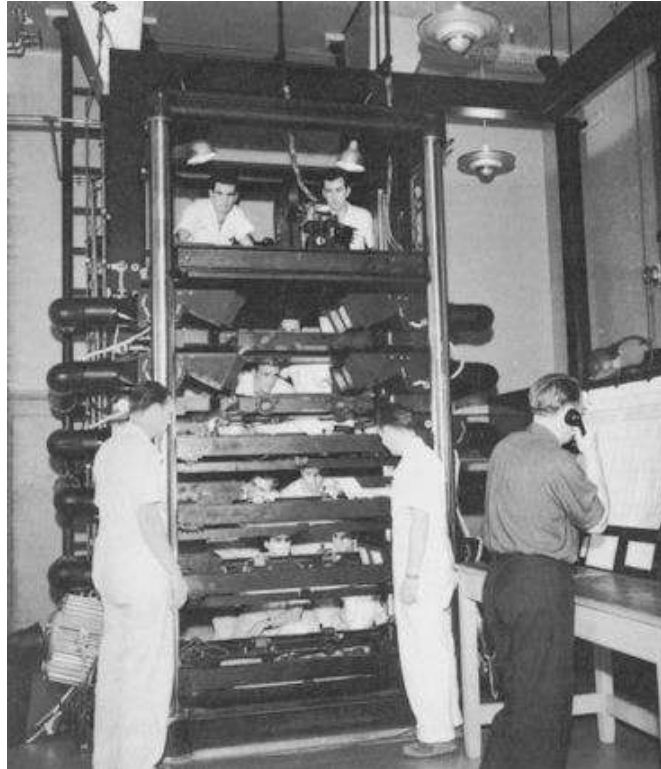
Εικόνα 1.14 Η πολυεπίπεδη κάμερα του Disney
