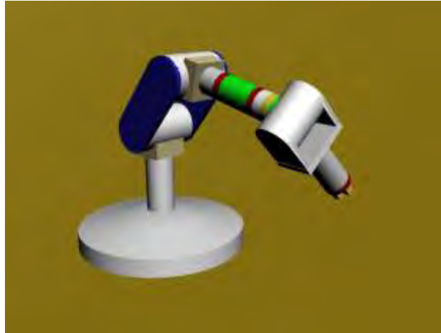
Εικόνα 4.4 Για να υπολογιστεί η θέση της άκρης του χεριού του ρομπότ θα χρησιμοποιηθεί forward kinematics
