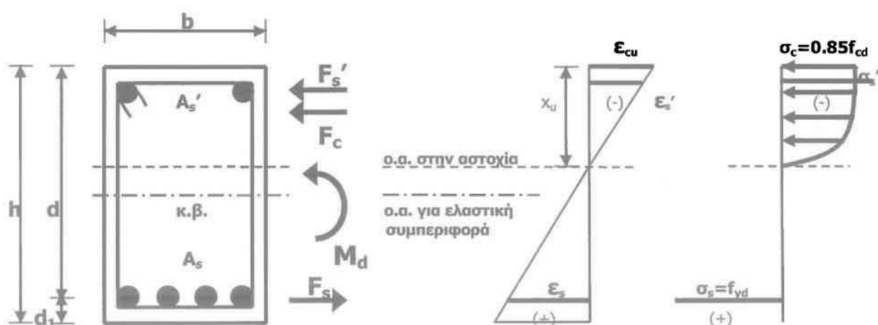
Σχήμα 6. Εσωτερικές και εξωτερικές δυνάμεις, ανηγμένες παραμορφώσεις και κατανομή τάσεων σε ορθογωνική διατομή από οπλισμένο σκυρόδεμα με διπλό οπλισμό, κατά την οριακή κατάσταση αστοχίας σε κάμψη (ΕΚΩΣ 2000).
