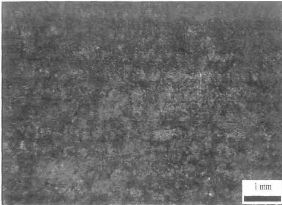
Σχήμα 6-13: Φωτογραφία από στερεοσκόπιο της επιφάνειας δοκιμίων της σειράς 2 μετά από 75 μέρες παραμονής στο διαβρωτικό περιβάλλον.
