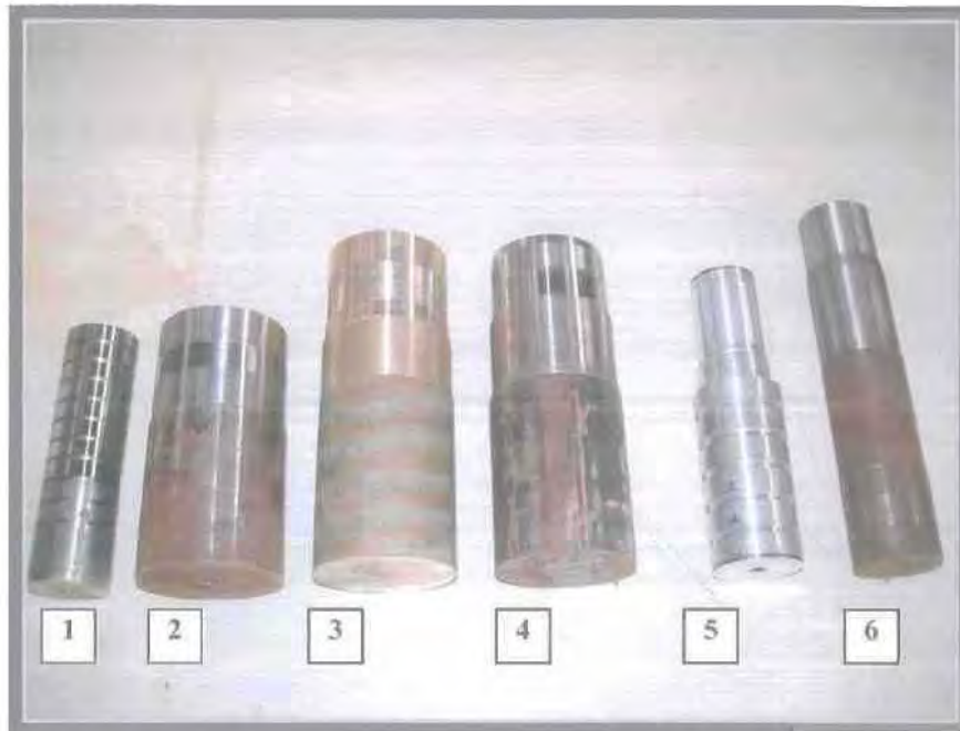
Εικόνα 1. Τα κατεργαζόμενα μεταλλικά υλικά: 1. 304, 2. Cκ60, 3. Ορείχαλκος , 4. St37 , 5. Αλουμίνιο, 6. C35
