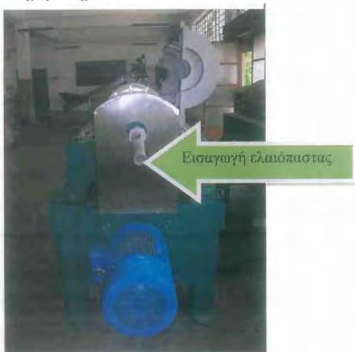
Εικόνα 16: Σημείο εισαγωγής ελαιόπαστας στο Φυγοκεντρικό διαχωριστήρα
