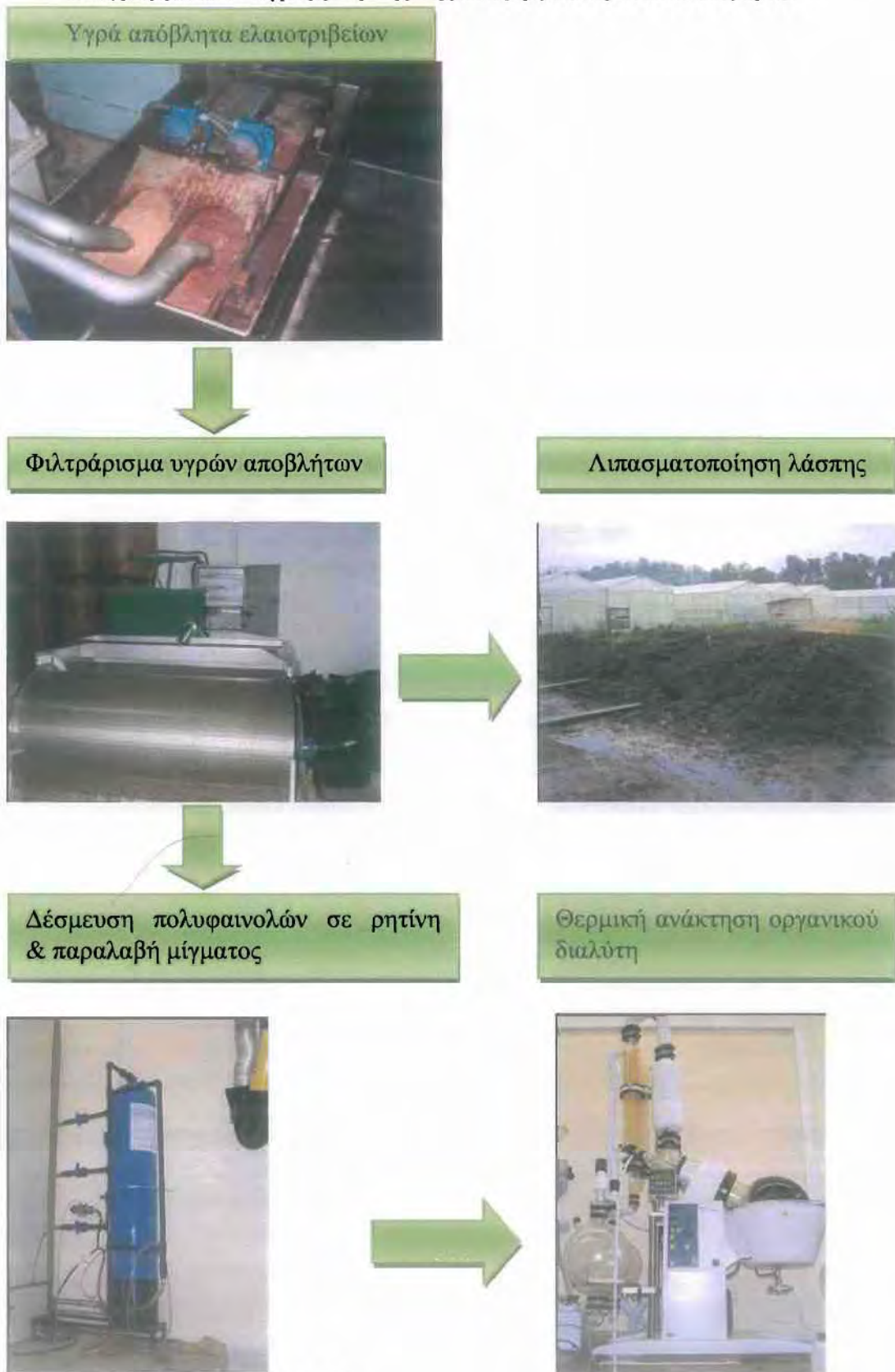
Διάγραμμα 6: Διάγραμμα ροής της επεξεργασίας του κατσίγαρου
