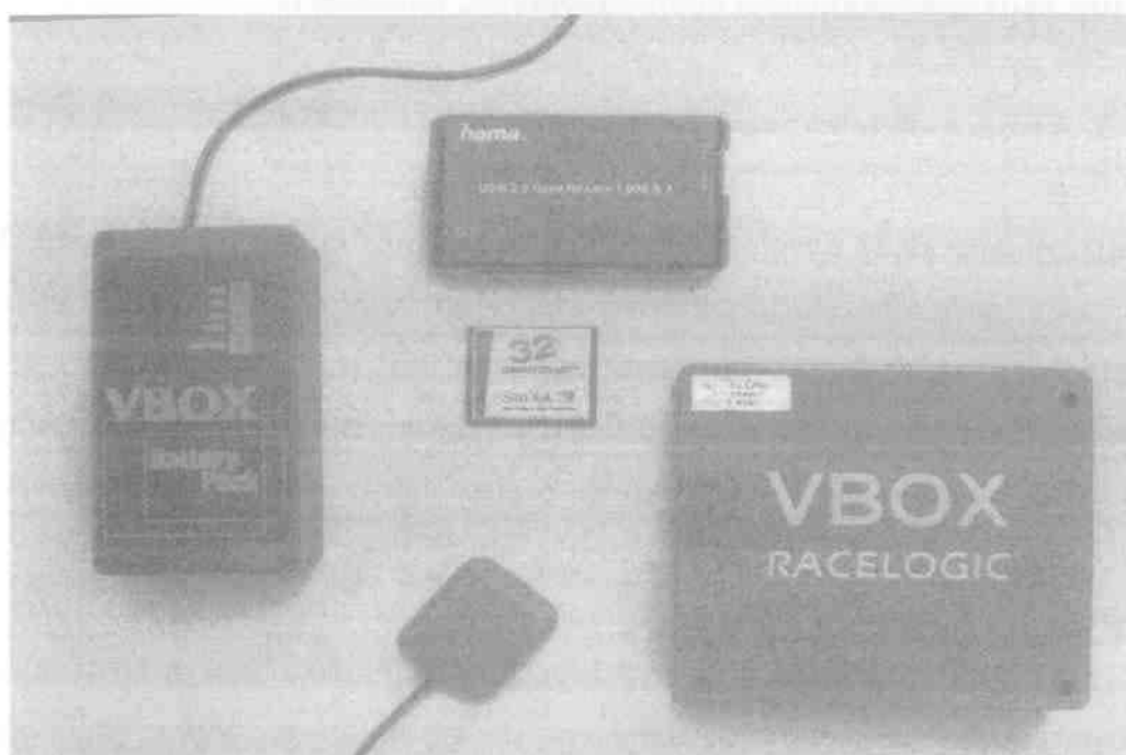
Εικόνα 41. Εξοπλισμός Vbox ( μπαταρία, κεραία, κάρτα δεδομένων, card reader).
