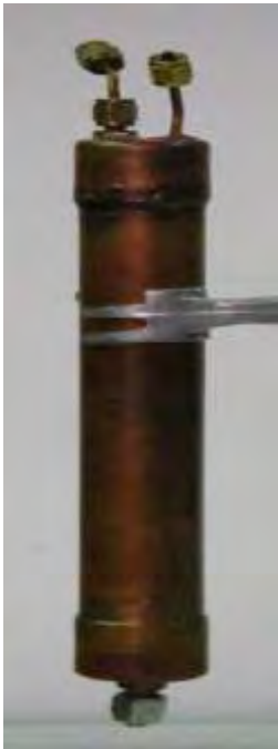
Σχήμα 4.4: Εξατμιστήρας ομογενοποίησης μίγματος.
