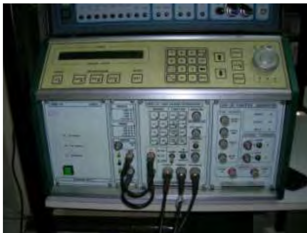
Σχήμα A.2: Ηλεκτροχημικός σταθμός AMEL5000
