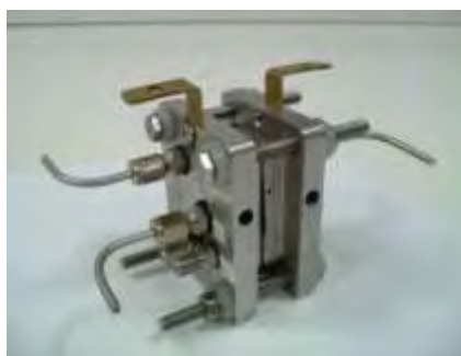
Σχήμα A.8: Συσκευή κυψελίδας καυσίμου πολυμερικής μεμβράνης
