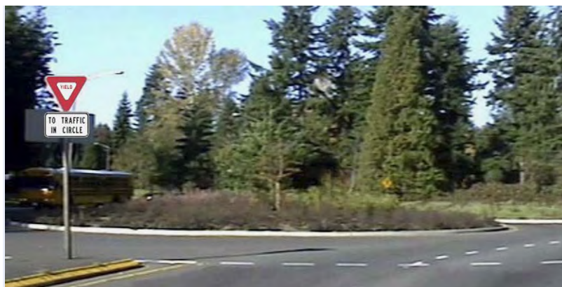
Εικόνα 5.24 Προτεινόμενη χρήση πινακίδα παροχής υποχρεωτικής προτεραιότητας που θα πρέπει να τοποθετείται και στις δυο πλευρές του δρόμου κατά την προσέγγιση σε έναν κυκλικό κόμβο
