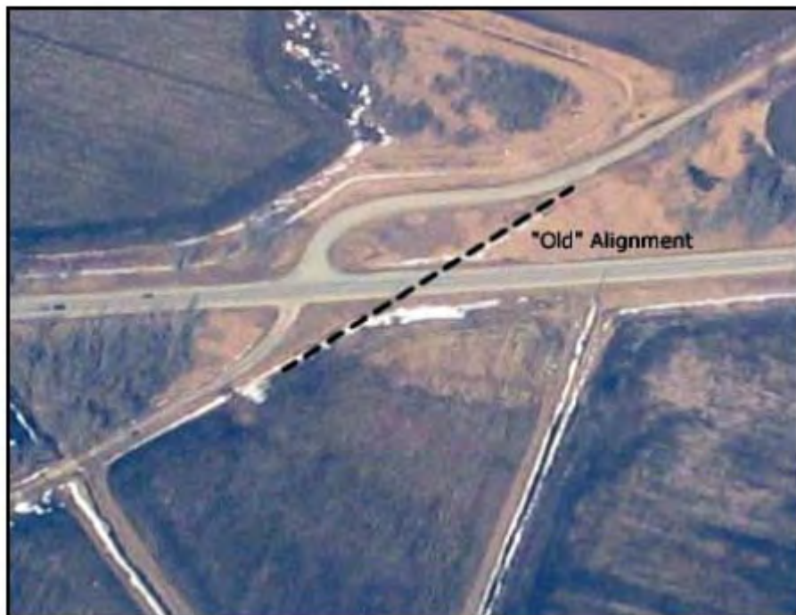
Εικόνα 5.2 Τροποποίηση χάραξης για αλλαγή γωνίας συμβολής (Federal Highway Administration)
