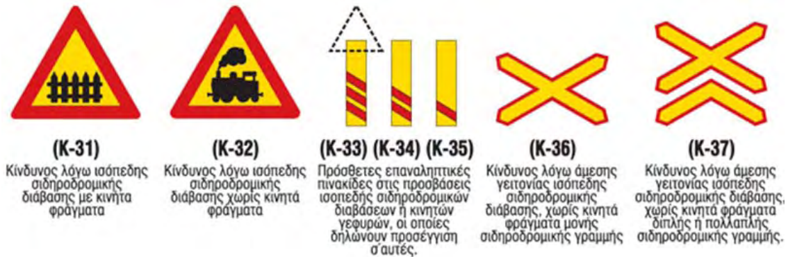
Εικόνα 5.30 Πινακίδες σήμανσης (πινακίδες κινδύνου) σε ισόπεδες σιδηροδρομικές διαβάσεις στην Ελλάδα (Πηγή: ΣΗΜΑ Α.Β.Ε.Ε.)
