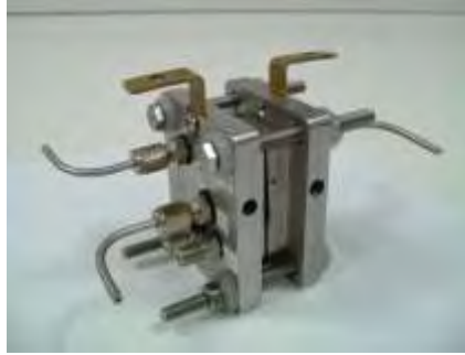
Σχήμα 3. 2: Κυψελίδα Καυσίμου Πολυμερικής Μεμβράνης
