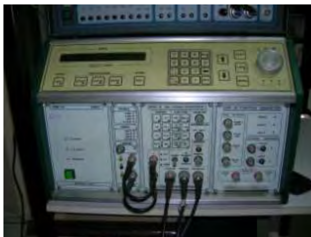
Σχήμα 3. 6: Ηλεκτροχημικός σταθμός AMEL5000
