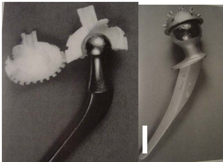
ΕΙΚΟΝΑ 28. ΔΕΞΙΑ: Ολική Charnley με κοπέλιο από Teflon που οδήγησε σε απογοητευτικά αποτελέσματα. ΑΡΙΣΤΕΡΑ: Πρόθεση . McKee-Farrar με μεταλλικές επιφάνειες τριβής. Οι σχεδιαστικές αδυναμίες του κοπελίου συνοδεύτηκαν από συχνές πρώιμες αποτυχίες
