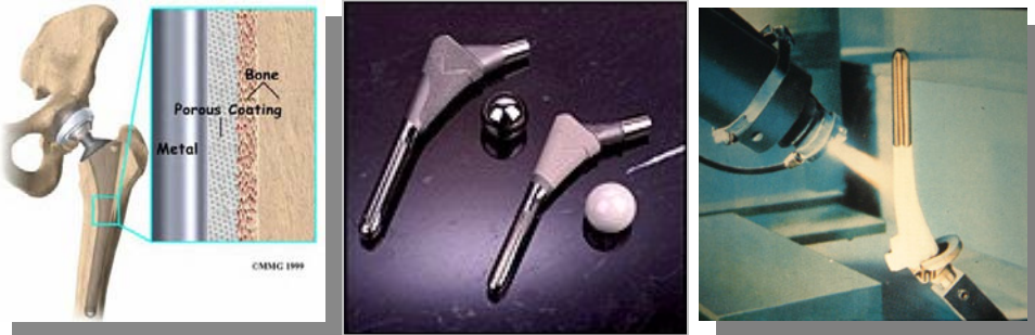
EIKONA 33. Α. Σχηματική απεικόνιση της διεπιφάνειας με υλικά με επικάλυψη HA. Β. Στελλεοί με και χωρίς επικάλυψη. Γ. Plasma deposition process
