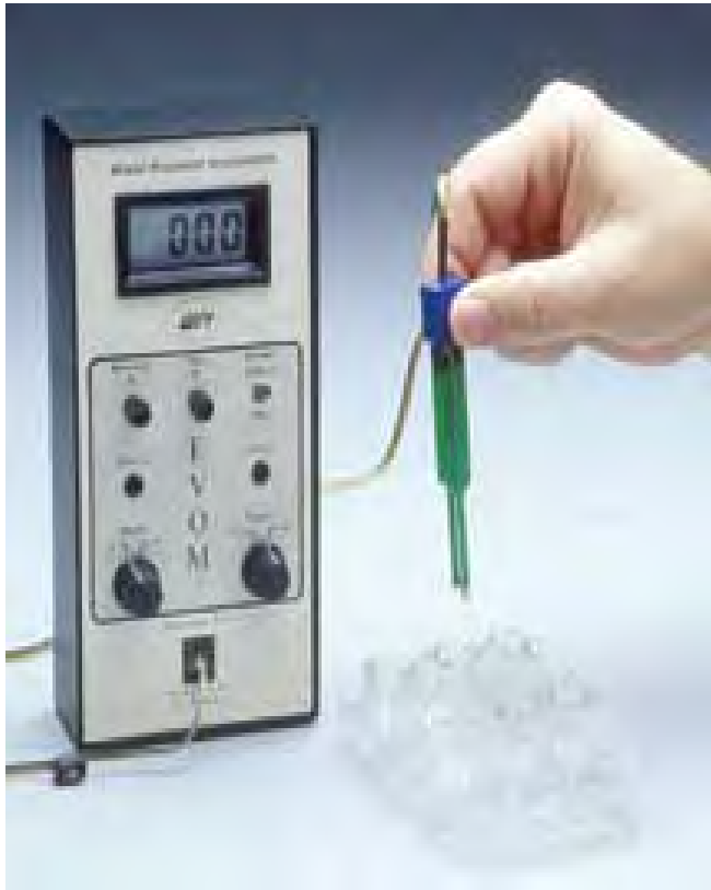
Εικόνα 5: Η συσκευή EVOMX με την οποία μετρούνταν η αντίσταση των μεσοθηλιακών απευθείας από την καλλιέργεια.
