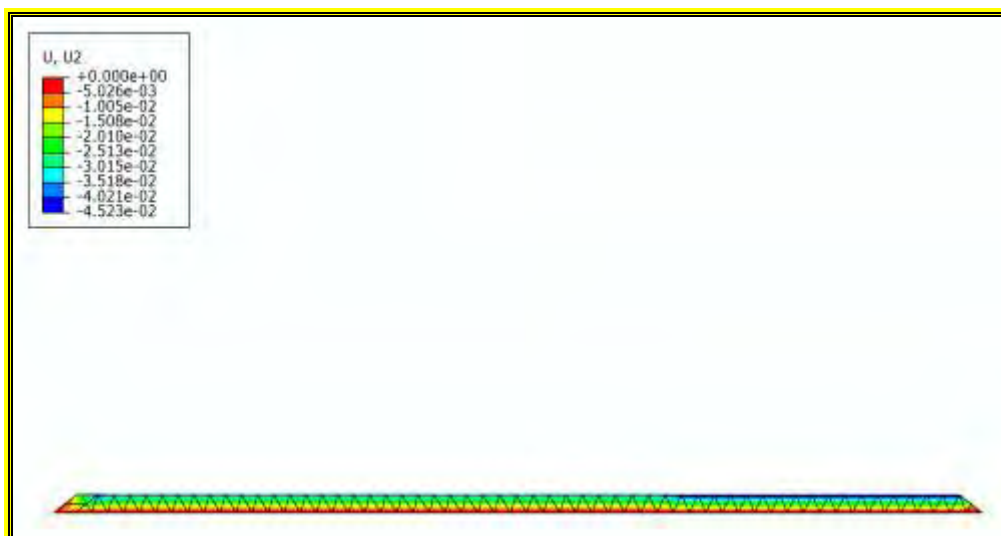
Σχ. 24: 1 η στρώση στην κατασκευή του επιχώματος (βήμα 1)
