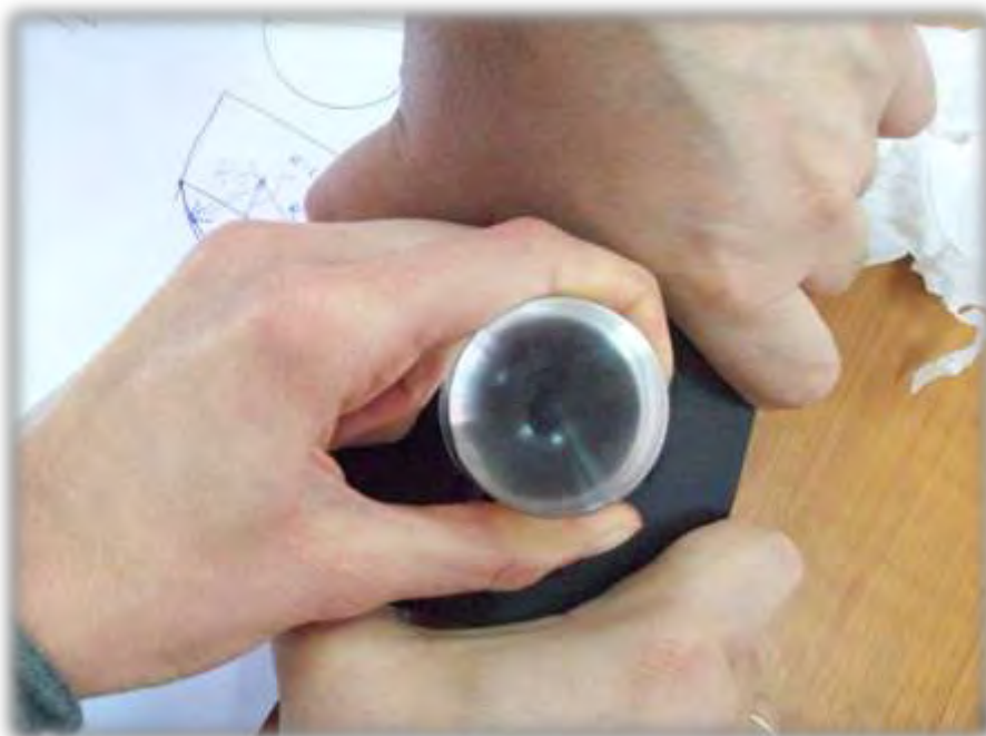
Εικόνα 3.19.11 Το ελαστικό της προηγούμενης εικόνας υποβάλλεται σε δοκιμή κάμψης γύρω από έναν χαλύβδινο σωλήνα. Η ανωτέρω στρώση του δείγματος υποβάλλεται σε ελκυσμό, ενώ η κατώτερη στρώση που εφάπτεται στο σωλήνα σε θλίψη. Έτσι λοιπόν, η εξωτερική επιφάνεια προεντείνεται και το αποτύπωμα του διεισδυτή πάνω στο ελαστικό έχει τη μορφή έλλειψης.
