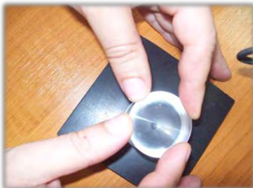
Εικόνα 3.19.10 Διαφανής διεισδυτής εισχωρεί σε απαραμόρφωτο ελαστικό «σώμα». Το αποτύπωμα του διεισδυτή πάνω στο δοκίμιο έχει τη μορφή κύκλου, όπως φαίνεται στην εικόνα.
