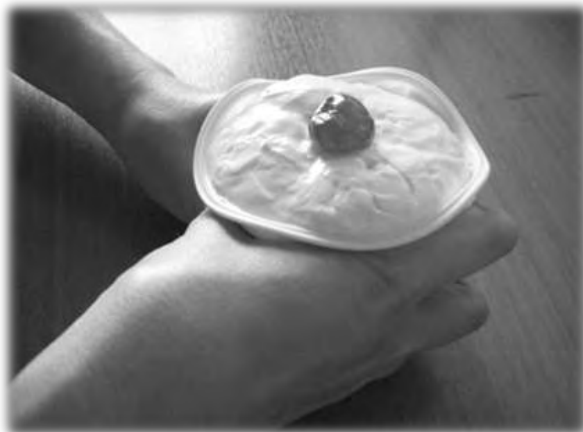
Εικόνα 4.4.6 Περίσφιξη περιμετρικά του δοκιμίου. Στο δείγμα επιβάλλουμε μεγάλο θλιπτικό φορτίο σε όλο το μήκος της περιμέτρου του. Αυτό έχει ως αποτέλεσμα την έντονη ανύψωση του γιαουρτιού, όπως μπορούμε να διακρίνουμε στην εικόνα. Η ανύψωση του δοκιμίου οφείλεται στο γεγονός ότι το γιαούρτι ανήκει στην κατηγορία των ασυμπιέστων υλικών, όπως προαναφέρθηκε.
