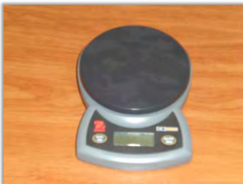
Εικόνα 4.3.2 Ζυγός ακριβείας με κωδικό OHAUS-CS 2000. Ο εικονιζόμενος ζυγός χρησιμοποιήθηκε πριν την υλοποίηση των πειραμάτων (pull out test και bending test) για τη μέτρηση του βάρους των συστατικών που αποτελούν το σύνθετο υλικό που παρασκευάστηκε (Gel αναμεμιγμένο με πούδρα τάλκης).
