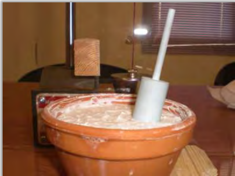
Εικόνα 4.3.14 Τελική θέση του εμβόλου μετά την επιβολή της οριζόντιας δύναμης.
