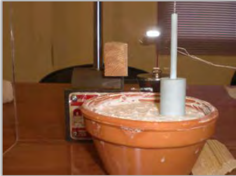
Εικόνα 4.3.13 Αρχική κατάσταση του δείγματος, πριν το πείραμα της καμπτικής διείδυσης. Η βάση του επίπεδου διείδυτη είναι τοποθετημένη κοντά στο σύνορο του δοχείου. . Ειδικότερα, φαίνεται η αρχική θέση του εμβόλου πριν την επιβολή της οριζόντιας δύναμης-στροφής. Αντίθετα με το προηγούμενο πείραμα καμπτικής διείδυσης, η κλωστή σύνδεσης με το δυναμόμετρο βρίσκεται στην κάτω οπή.
