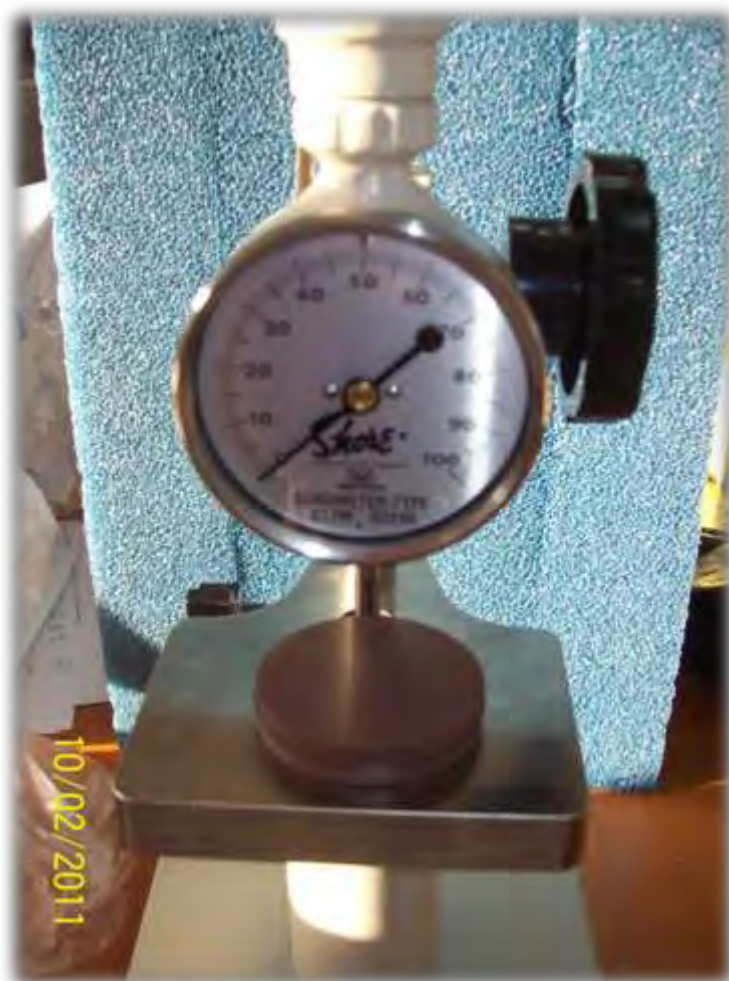
Εικόνα 2.13.15 Στην εικόνα φαίνεται το καφέ (brown) δοκίμιο, η σκληρότητα του οποίου δίνεται από την εταιρία 81.5 μετρούμενη με όργανο Shore κλίμακας M. Στο εργαστήριο τα πειράματα που εκτελέστηκαν επαληθεύουν τις προδιαγραφές δίνοντας σκληρότητα ίση με 81.48 χρησιμοποιώντας την ίδια συσκευή. Τα αποτελέσματα σε αυτή την περίπτωση ταυτίζονται.
