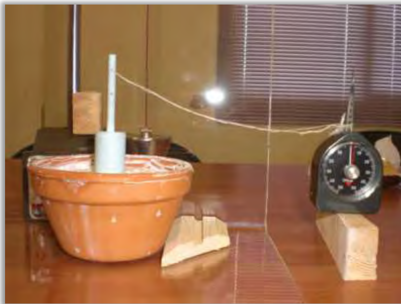
Εικόνα 4.3.8 Απεικόνιση του συστήματος πριν την υλοποίηση του πειράματος της καμπτικής διεύθυνσης (τοποθετημένη κλωστή στην άνω οπή του επίπεδου διευσδυτή). Το επίπεδο έμβολο (flat punch) πολυουρεθάνης επικάθεται απλά πάνω στο δοκίμιο τύπου Gel και συνδέεται οριζόντια, μέσω μίας κλωστής, με το δυναμόμετρο (Σουηδικής προέλευσης). Η θέση του δυναμόμετρου είναι τέτοια ώστε να μπορεί να επιβληθεί η οριζόντια δύναμη στο έμβολο μέσω του δυναμόμετρου και ύστερα να ακολουθήσει η μέτρηση της στροφής του εμβόλου σε σχέση με την αρχική του κατάσταση, όταν αυτό εδράζεται απλά πάνω στο παρασκευασμένο μίγμα.
