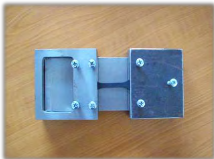
Εικόνα 3.18.7 Ελαστικό δοκίμιο G&T εδράζεται απλά πάνω στη μεταλλική βάση της συσκευής προέντασης χωρίς να έχει υποστεί «τέντωμα».
