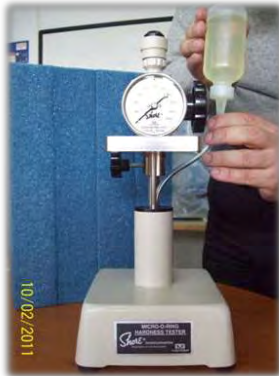
Εικόνα 2.13.7 Πλήρωση με λάδι του υδραυλικού κυλινδρικού δοχείου στη βάση του σκληρόμετρου Shore κλίμακας M. Το πλαστικό δοχείο που περιέχει το λάδι συνδέεται με τον διάφανο πλαστικό σωλήνα και αυτός με τη σειρά του με την τάπα στο ανώτερο τμήμα της επιφάνειας του κυλίνδρου, όπως φαίνεται στην εικόνα, με στόχο την μεταφορά του λαδιού στο εσωτερικό του κυλίνδρου του οργάνου. Το πλαστικό δοχείο «πιέζεται» σε τακτά χρονικά διαστήματα, έτσι ώστε το λάδι να εισχωρήσει στον κύλινδρο.
