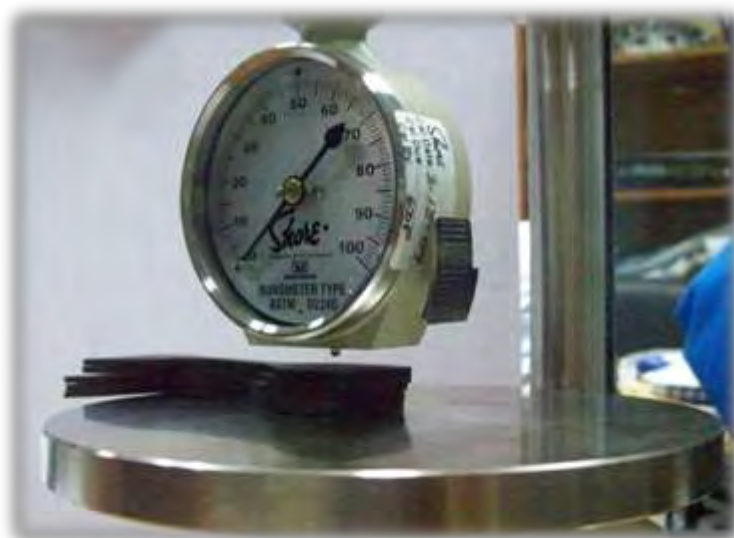
Εικόνα 1.16.6 Πλάγια όψη του σκληρόμετρου Shore λίγο πριν τη μέτρηση της σκληρότητας του δείγματος που αποτελείται από ένα πλήθος ομοειδών δοκιμίων.
