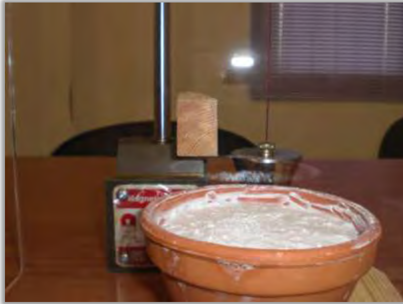
Εικόνα 4.3.7 Στην παραπάνω φωτογραφία απεικονίζεται το τελικό μίγμα που παρασκευάστηκε. Στο βάθος της φωτογραφίας φαίνεται το διάφανο υπόβαθρο (cast acrylic sheets-Setacryl) και η μαγνητική βάση πάνω στην οποία τοποθετείται το νήμα της στάθμης.
