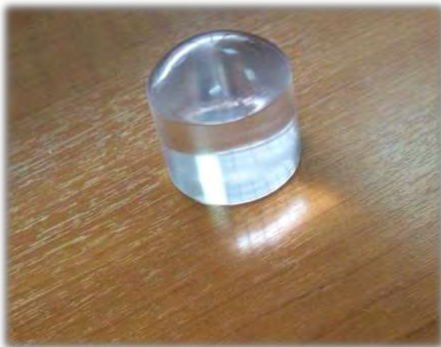
Εικόνα 3.19.9 Διαφανής διεισδυτής διαμέτρου D=4 cm. Η ακτίνα του σφαιρικού διεισδυτή R ισούται με 2.5 cm.
