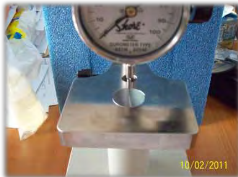
Εικόνα 2.13.8 Το μεταλλικό, άκαμπτο υπόβαθρο της προηγούμενης εικόνας τοποθετημένο στην υποδοχή που έχει το «τραπέζι» της συσκευής Shore
