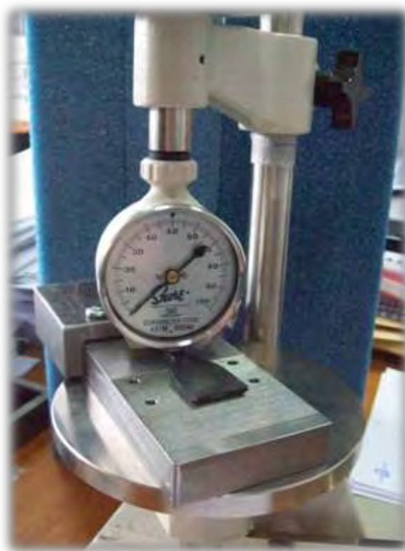
Εικόνα 3.19.7 Στην εικόνα φαίνεται το ελαστομερές δείγμα G&T απλά εδρασμένο πάνω στη συσκευή προέντασης πριν τη δοκιμή σκληρομέτρησης.
