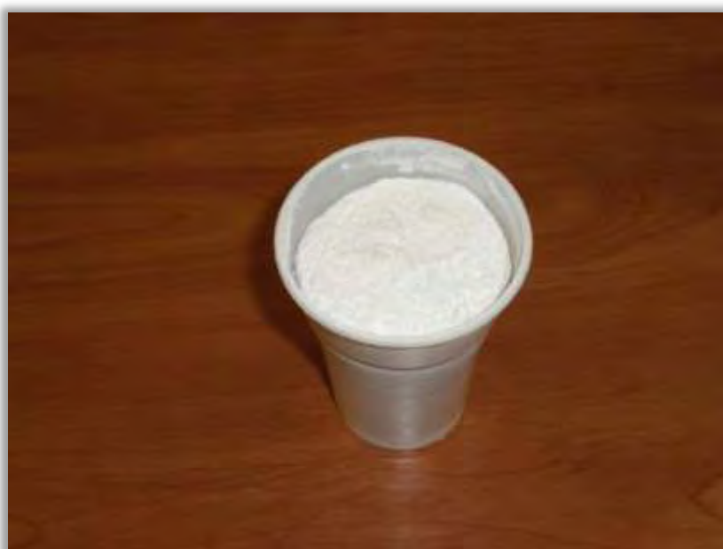
Εικόνα 4.3.3 Δοχείο μέσα στο οποίο τοποθετήθηκε ορισμένη ποσότητα πούδρας (powder-talc), βασικό συστατικό για την παρασκευή του τελικού μετρούμενου δείγματος. Το εικονιζόμενο άδειο δοχείο ( χωρίς το βάρος του Powder-talc ) έχει βάρος ίσο με 3 gr, έπειτα από τρεις διαδοχικές μετρήσεις. Αντίθετα, το συνολικό βάρος του δοχείου μέσα στο οποίο έχει τοποθετηθεί Powder-talc μετρήθηκε ίσο με 130 gr. Επομένως, το συνολικό βάρος της πούδρας που εμπεριέχεται στο δοχείο ισούται με 127 gr (130 gr - 3 gr).
