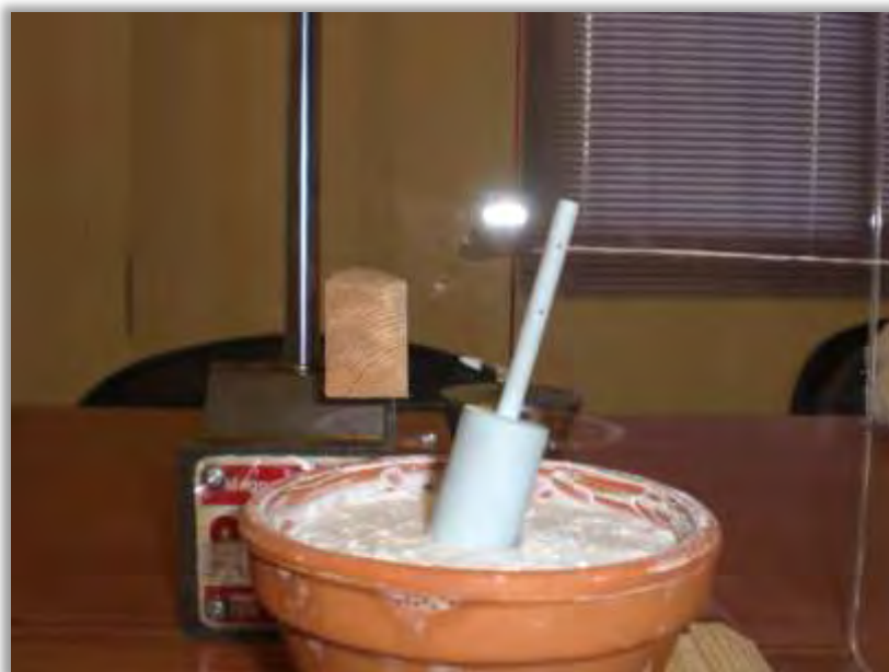
Εικόνα 4.3.10 Στην παραπάνω φωτογραφία παριστάνεται το πείραμα της καμπτικής διείδυσης (bending test). Ειδικότερα, μπορούμε να δούμε την τελική θέση-στροφή του επίπεδου διεσδυτή μετά την επιβολή της οριζόντιας δύναμης.
