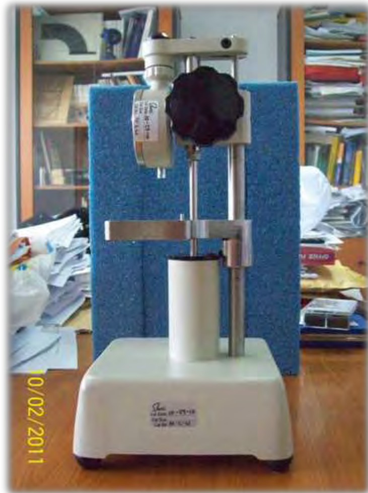
Εικόνα 2.13.3 Πλάγια όψη του σκληρόμετρου Shore κλίμακας M. Στη φωτογραφία διακρίνεται η κυκλική αναλογική οθόνη του οργάνου κλίμακας εύρους μεταξύ 0 και 100, το άκαμπτο υπόβαθρό πάνω στο οποίο επικάθεται το δείγμα και ο υδραυλικός κύλινδρος λαδιού που καθορίζει την ταχύτητα της δοκιμής. Συσκευές τέτοιου τύπου βρίσκουν εφαρμογή σε πολύ λεπτά ελαστομερή υλικά αλλά και σε δοκίμια με ιδιόμορφο σχήμα.
