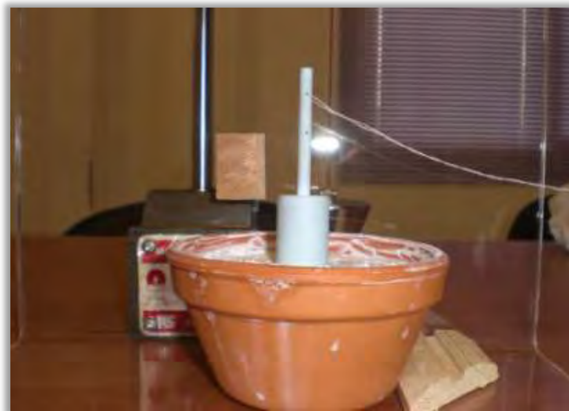
Εικόνα 4.3.9 Επίπεδος διεσδυτής επικάθεται απλά πάνω στο υπό εξέταση υλικό. Το «σώμα» βρίσκεται στην αρχική του απαραμόρφωτη κατάσταση (reference configuration), πριν την εκτέλεση του πειράματος της καμπτικής διείδυσης.
