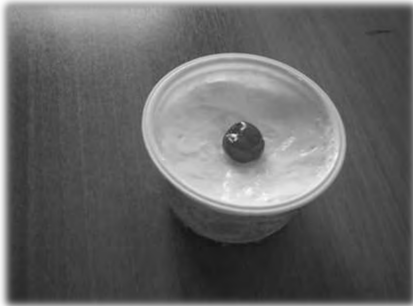
Εικόνα 4.4.5 Το δείγμα μετά την επιβολή μικρού θλιπτικού φορτίου. Μετά την περίσφιξη του υλικού, το δείγμα αφήνεται ελεύθερο να επιστρέψει στην αρχική του κατάσταση. Όπως μπορούμε να διακρίνουμε παραπάνω, η επιφάνεια του γιαουρτιού δεν παρουσιάζει μεγάλες μεταβολές συγκρινόμενη με εκείνη που αντιστοιχεί στην τελείως απαραμόρφωτη κατάσταση, ενώ το κεράσι συνεχίζει να επικάθεται πάνω στο υλικό.
