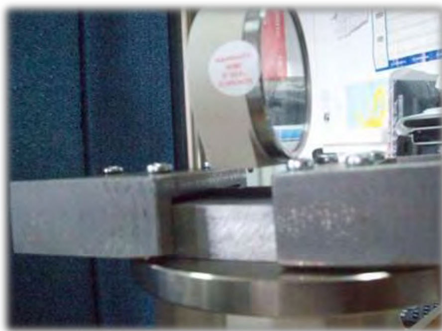
Εικόνα 3.19.6 Σκληρομέτρηση ελαστικού κατά Shore κλίμακας O. Το δείγμα αποτελείται από δύο στρώματα του υλικού G&T, από τα οποία μόνο το ανωτέρω στρώμα προεντίνεται.
