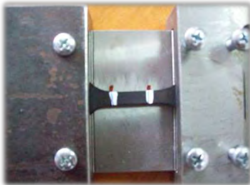
Εικόνα 3.19.4 Δοκίμιο απλά εδρασμένο σε συσκευή προέντασης. Στο ελαστικό G&T σημειώθηκε με λευκό χρώμα το αρχικό μήκος του δοκιμίου πριν την επιβολή μονοαξονικής προέντασης (reference configuration).
