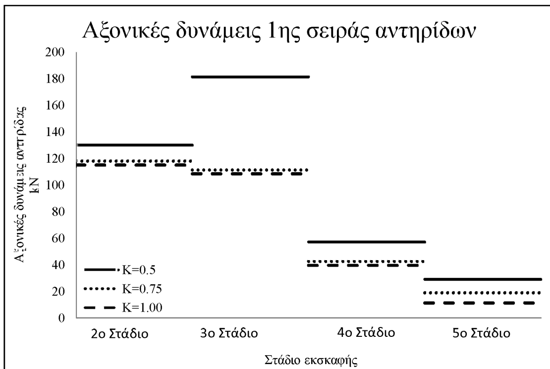
Σχήμα 4.27 Αξονικές δυνάμεις 1 ης σειράς αντηρίδων για διάφορες τιμές του συντελεστή ωθήσεων ηρεμίας K_o με χρήση καταστατικού νόμου Double-Yield σε όλα τα στάδια εκσκαφής
