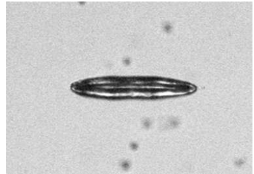
Σχήμα 4.11 Αρχικό σχήμα Φυσαλίδας Ενέργειας 38 μJ
