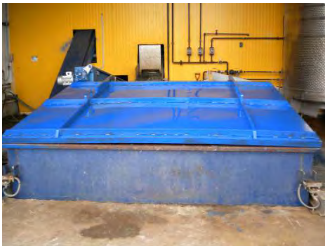
Εικόνα 15: Χοάνη παραλαβής υποπροϊόντων (κεφάλια, πόδια, εντόσθια).
