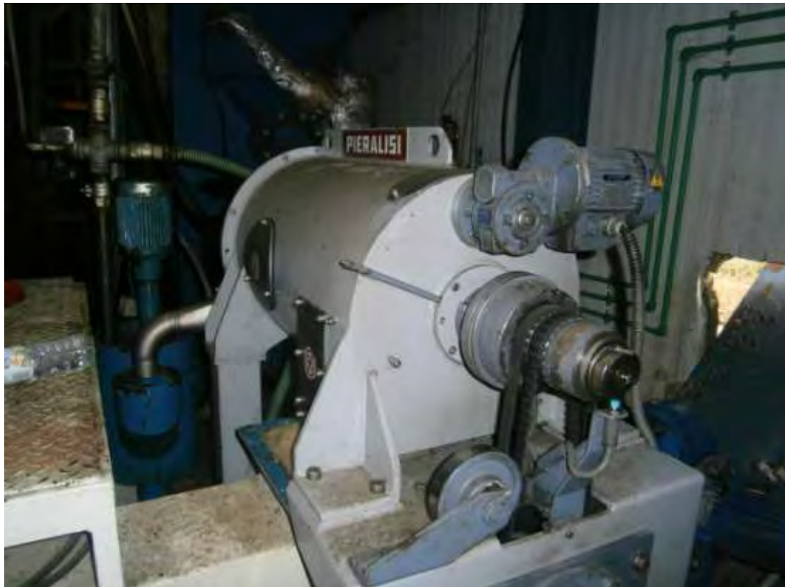
Εικόνα 21: Οριζόντιος φυγοκεντρικός διαχωριστής λίπους (decanter).
