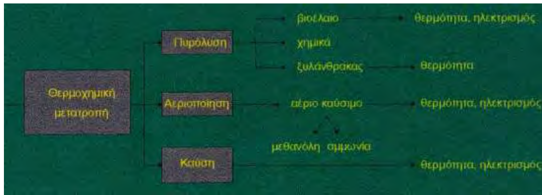
Εικόνα 5: Θερμοχημική μετατροπή της βιομάζας. (Πηγή: http://www.cres.gr/energy-saving/images/pdf/biomass_guide.pdf )
