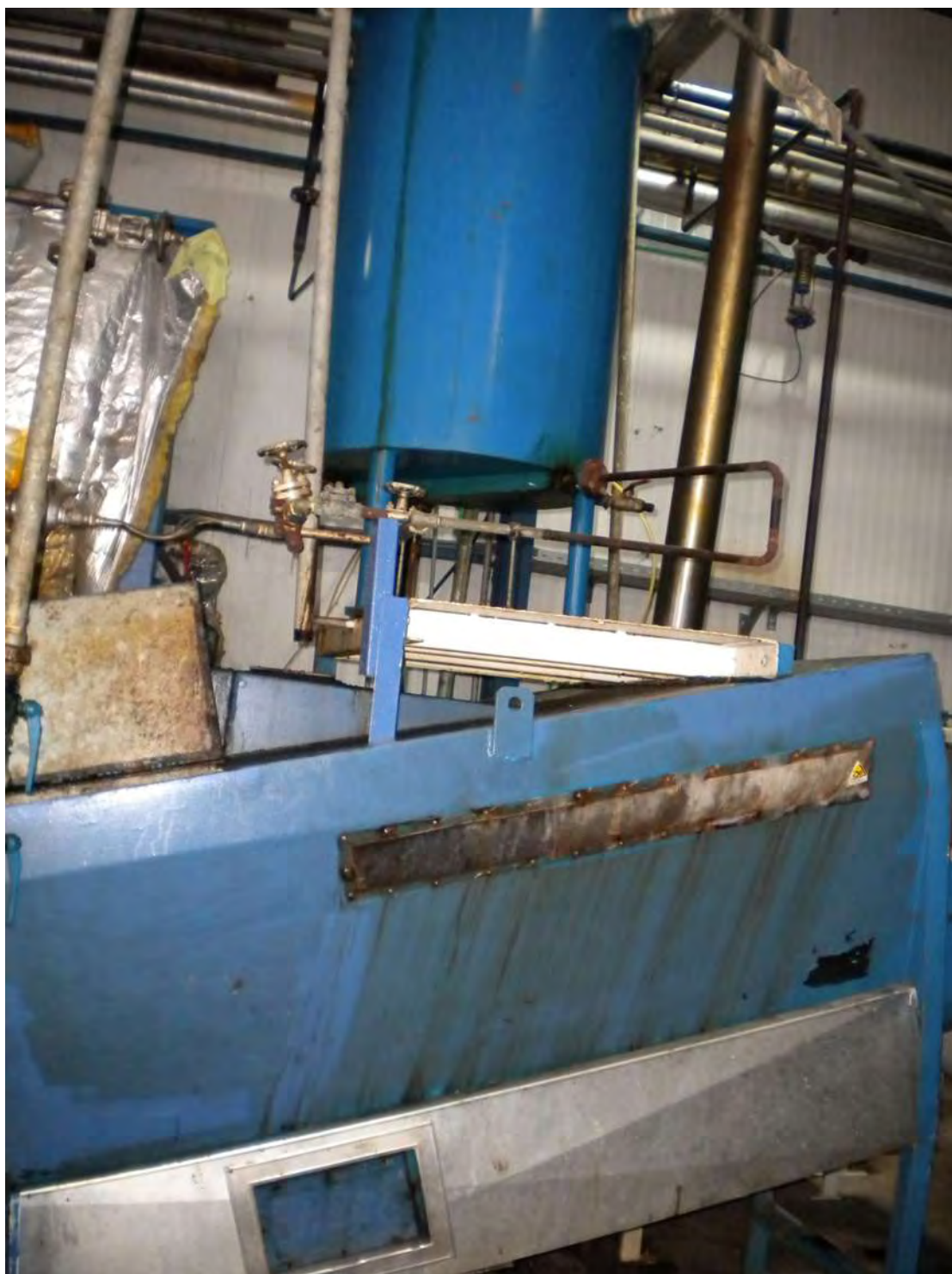
Εικόνα 19: Δεξαμενή διαχωρισμού λίπους-νωπού κρεατάλευρου (κάτω).
