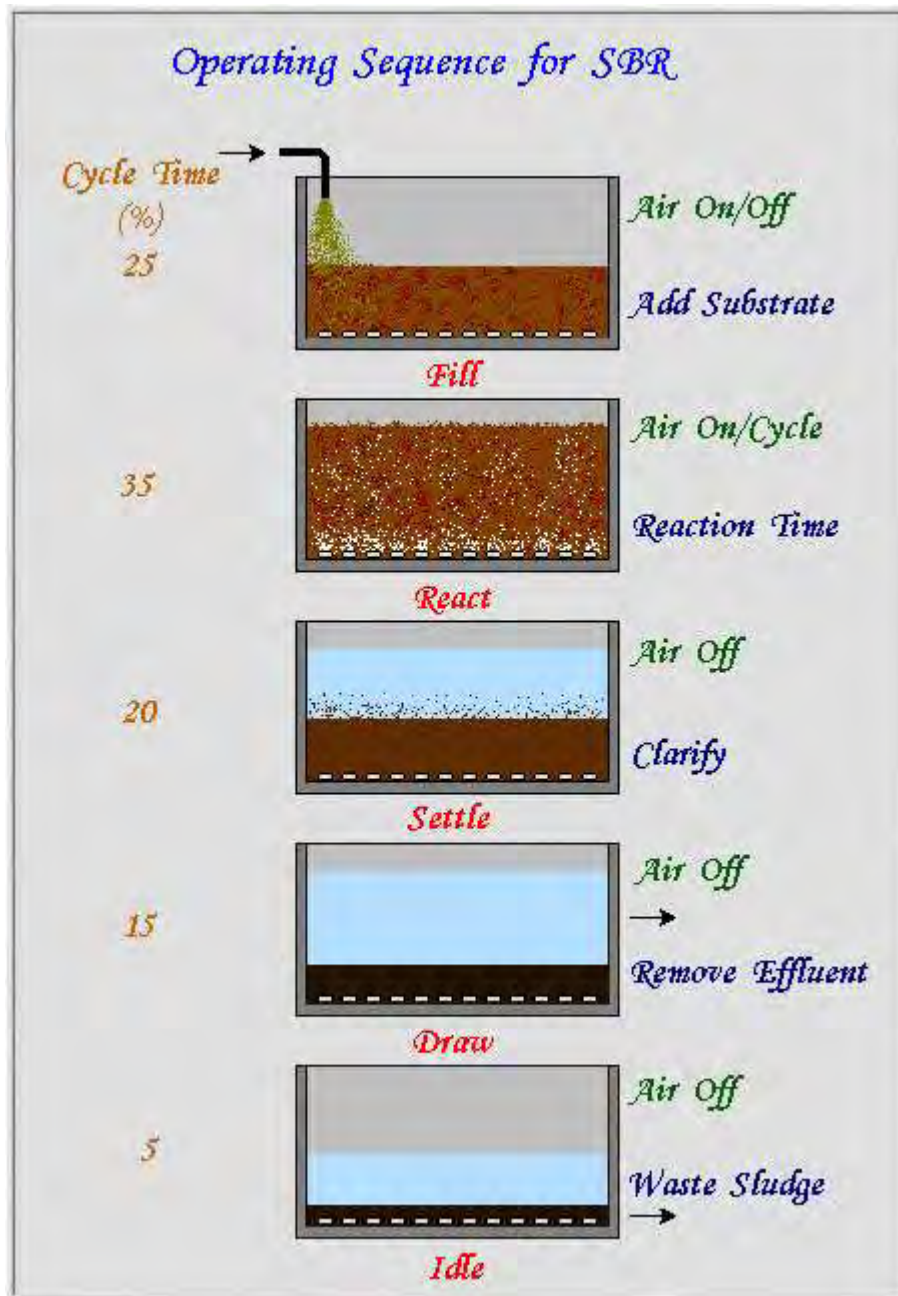
Εικόνα 40: Λειτουργική ακολουθία αντιδραστήρων SBR. (Πηγή:
