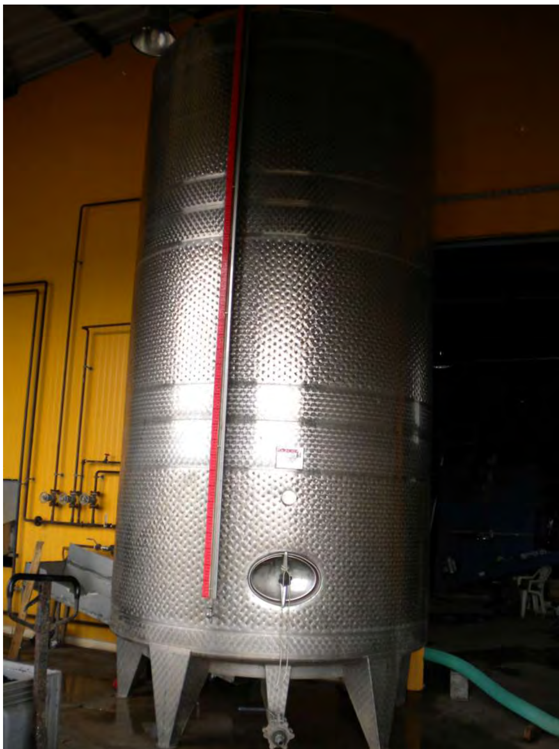
Εικόνα 28: Δεξαμενή αποθήκευσης λίπους «βιοντίζελ» (τελικό στάδιο).
