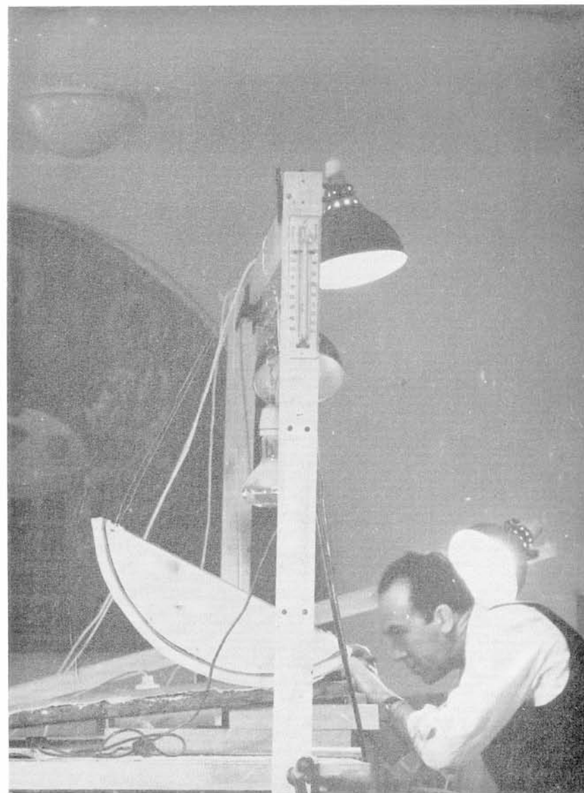
Βυζαντινόν Μουσείον : α. Εἰκὼν Παναγίας Γλυκοφιλούσης, 17ου αἰ. ( Β.Μ. 137 ), β. Συσκευὴ κατασκευασθεῖσα εἰδικῶς διὰ τὸν ἀποχωρισμὸν τῶν δύο στρωμάτων τῆς εἰκόνας α
