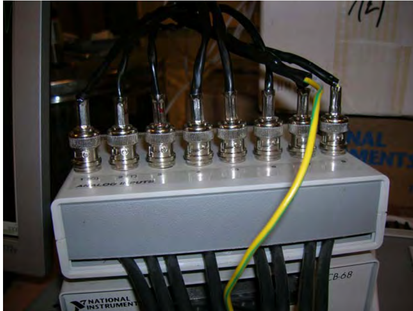
Σχήμα 2.10 Μετατροπέας αναλογικού σήματος thermistors σε ψηφιακό.
