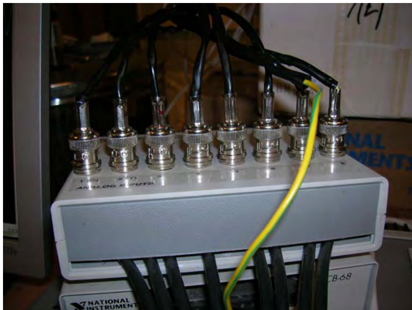
Σχήμα 2.10 Μετατροπέας αναλογικού σήματος thermistors σε ψηφιακό.
