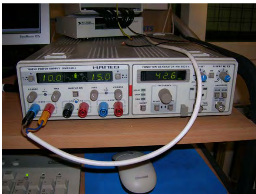
Σχήμα 2.11 Τροφοδοτικό τάσης της συστοιχίας των thermistors.
