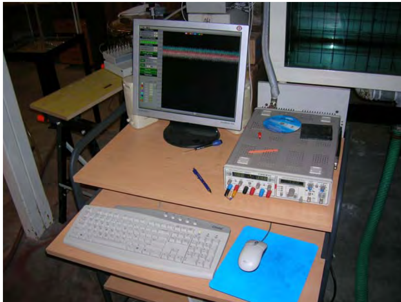
Σχήμα 2.13 Ηλεκτρονικός υπολογιστής και τροφοδοτικό τάσης των thermistors.
