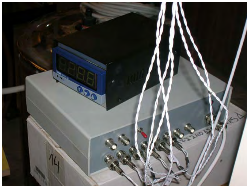
Σχήμα 2.9 Προενισχυτής σήματος thermistors και καταγραφικό θερμοκρασίας εισόδου.
