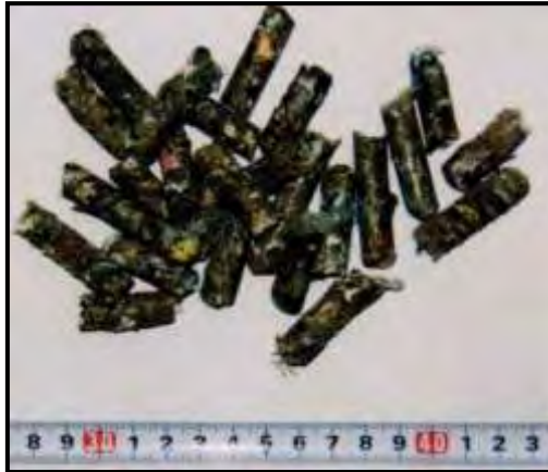
Εικόνα 9 Πελλετοποιημένο RDF (Japanese Advanced Environment Equipment, 2008)
