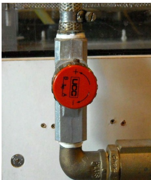
Σχήμα 3.8 Βάνα ακριβείας με βερνιέρο.
