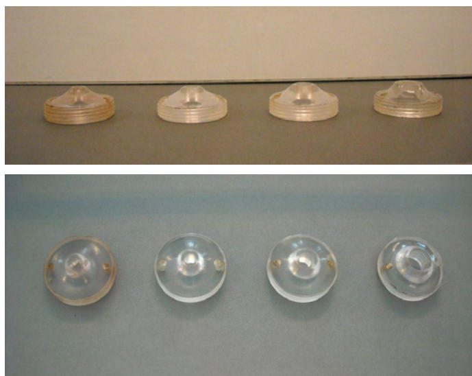
Σχήμα 3.3 Ακροφύσια κυκλικής διατομής διαμέτρων 0.50 cm, 0.75 cm, 1 cm και 1.50 cm που χρησιμοποιήθηκαν.
