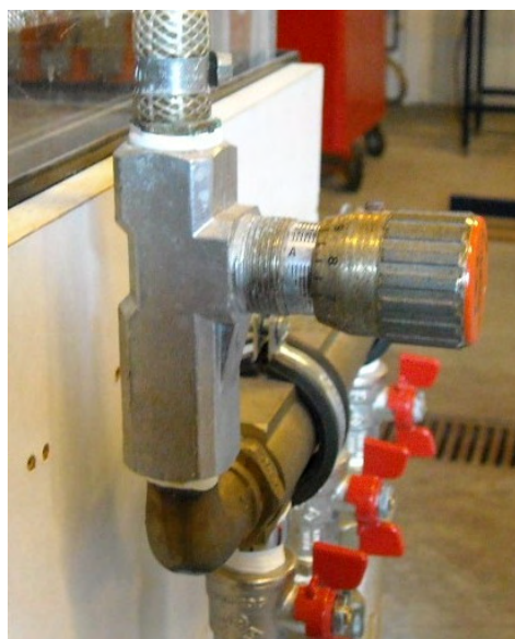
Σχήμα 3.8 Βάνα ακριβείας με βερνιέρο.
