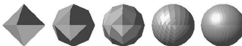
ΕΙΚΟΝΑ 186 FLAT ΣΚΙΑΣΗ ΣΕ ΣΦΑΙΡΑ ΜΕ ΔΙΑΦΟΡΕΤΙΚΗ ΨΗΦΙΟΠΟΙΗΣΗ
