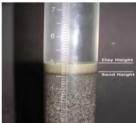
Εικόνα 3.5: Δοκιμή ισοδύναμου άμμου ( http://pavementinteractive.org ).
