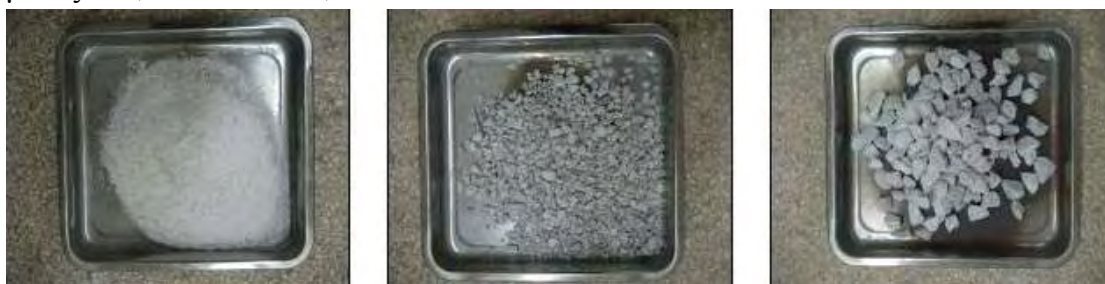
Εικόνα 3.1: Είδη αδρανών υλικών για την παρασκευή σκυροδέματος (άμμος – γαρμπίλι - χαλίκι) (Ματκάρης, 2009).
