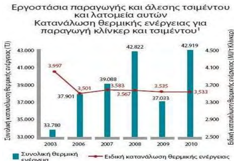
Σχήμα 6.5: Συνολική κατανάλωση θερμικής ενέργειας (TJ) και ειδική κατανάλωση θερμικής ενέργειας (MJ/τον κλίνκερ) για την παραγωγή κλίνκερ και τσιμέντου, των εργοστασίων παραγωγής και άλεσης τσιμέντου και των λατομείων, μεγάλης ελληνικής τσιμεντοβιομηχανίας ( www.titan.gr , ίδια επεξεργασία).
