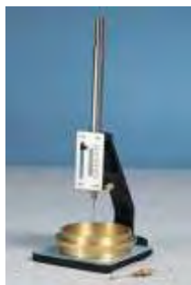
Εικόνα 2.3: Συσκευή Vicat, προσδιορισμού του χρόνου πήξης του τσιμέντου ( http://www.ele.com ).
