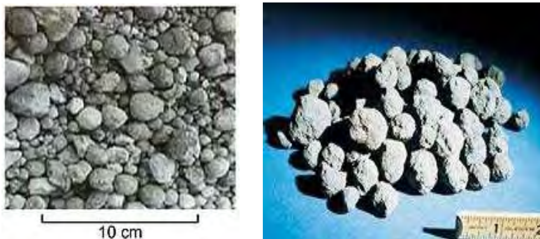
Εικόνα 2.6: Σφαιρίδια (pellets) μεγέθους 10,00–25,00 mm του κλίνκερ τσιμέντου. Προϊόν της διεργασίας της έψησης στην περιστροφική κάμινο.
