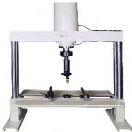
Εικόνα 2.1: Συσκευή ποιοτικού ελέγχου αντοχής σε κάμψη δοκιμίων ( http://www.eds.gr ).
