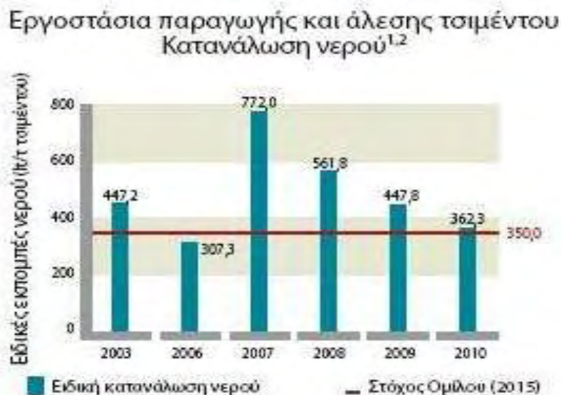
Σχήμα 6.7: Συνολική κατανάλωση νερού (λίτρα νερού/τοπ τσιμέντου) των εργοστασίων παραγωγής και άλεσης τσιμέντου, μεγάλης ελληνικής τσιμεντοβιομηχανίας ( www.titan.gr , ίδια επεξεργασία).
