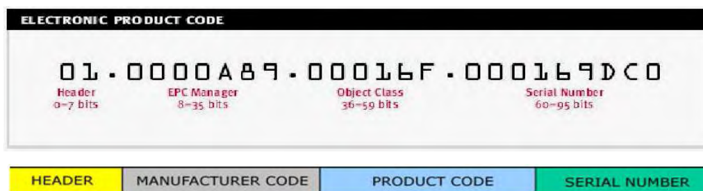
Εικόνα 3-6. Μορφή του EPC των 96bits (4bits / symbol) (με 79.2 τρις τρις συνδυασμούς) [15]
