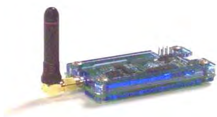
Εικόνα 3-4. (α) Active RFID - [ZR-USB from Tag-Sense]
