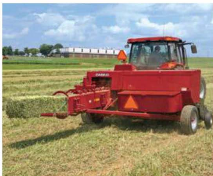
Εικόνα 3.2: Μηχάνημα δεματοποίησης μικρών ορθογώνιων δεμάτων
