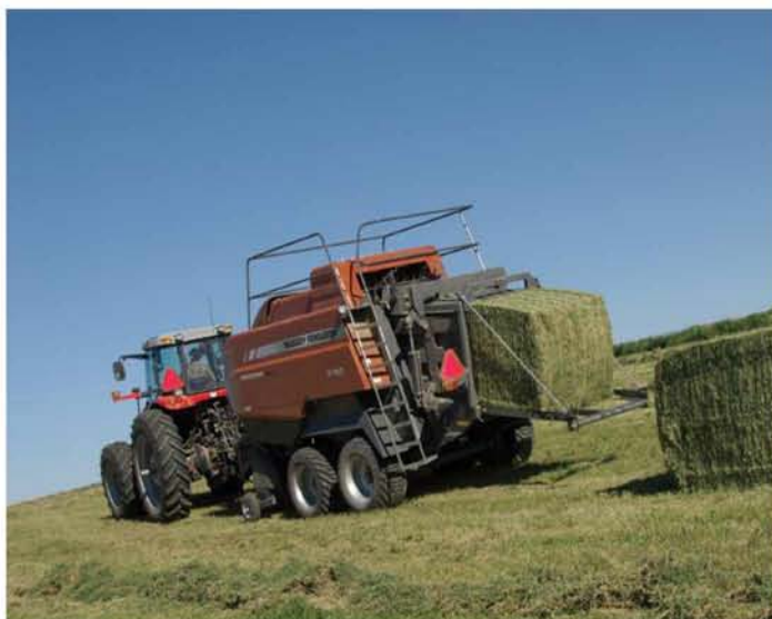
Εικόνα 3.3: Μηχάνημα δεματοποίησης μεγάλων ορθογώνιων δεμάτων
