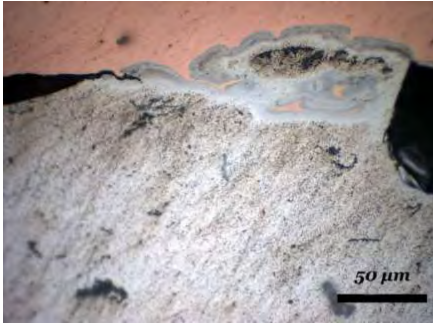
Εικ. 41: Περιοχή συγκόλλησης κατηγορίας Δ (500x)
