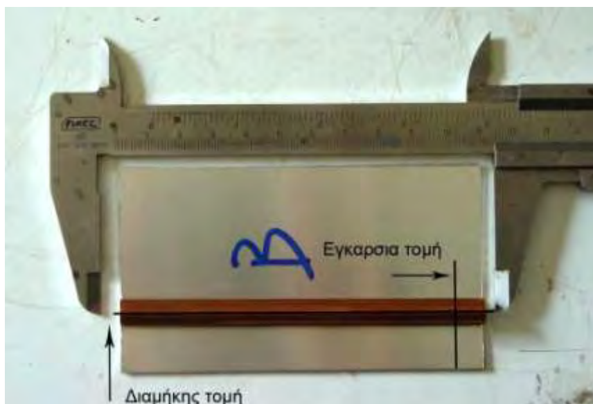
Εικ. 9: Σχηματική διαμήκους και εγκάρσιας τομής
