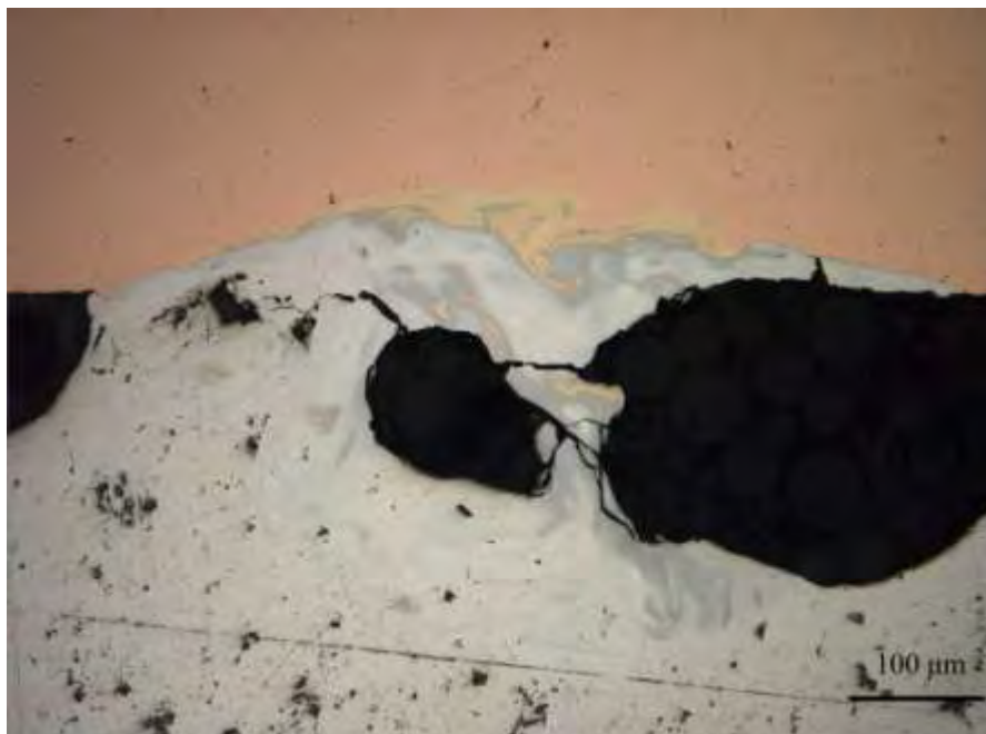
Εικ. 31: Περιοχή συγκόλλησης κατηγορίας Anew (200x)
