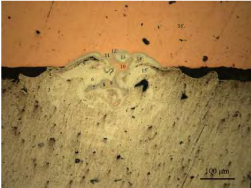
Εικ. 62: Περιοχή συγκόλλησης κατηγορίας ΣΤ, Σημεία μικροσκληρομέτρησης
