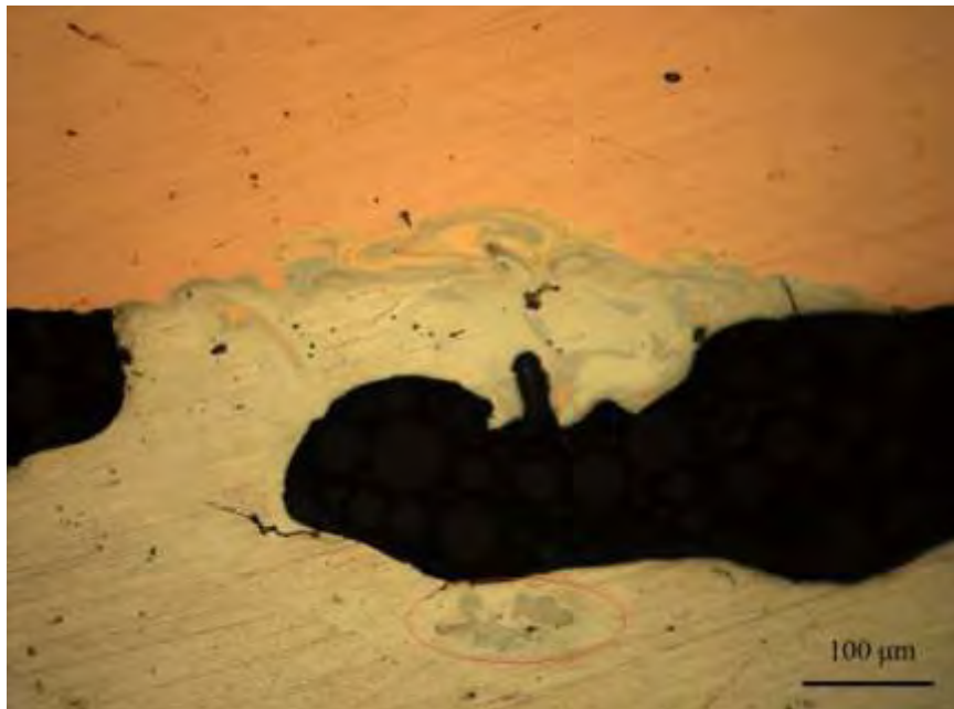
Εικ. 25: Περιοχή συγκόλλησης κατηγορίας B (200x)
