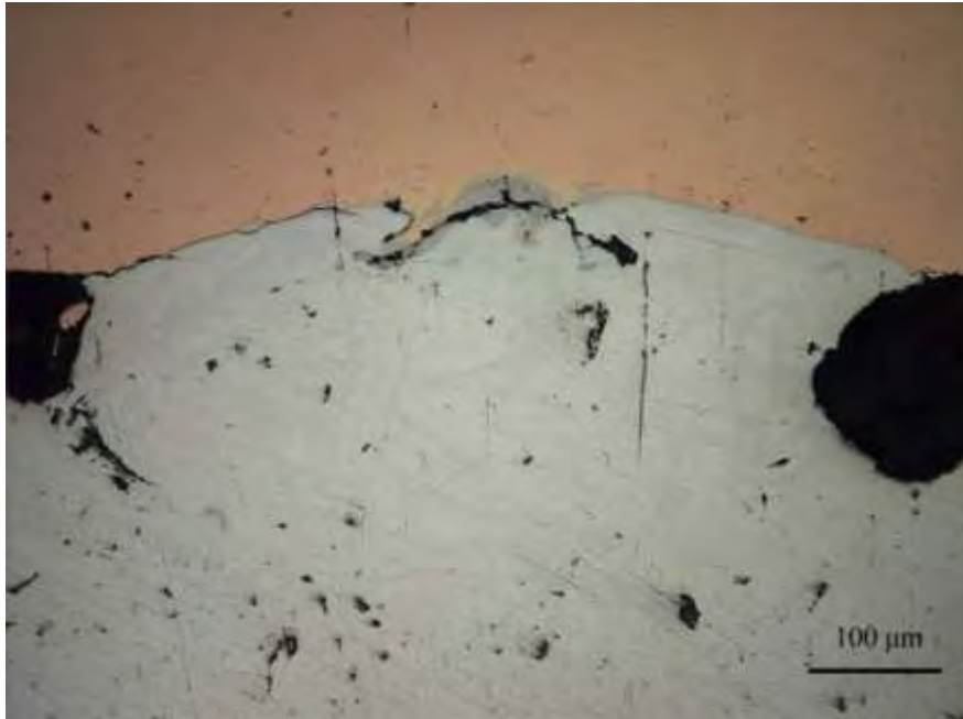
Εικ. 28: Περιοχή συγκόλλησης κατηγορίας Anew (200x)
