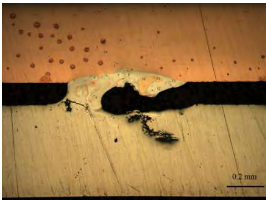
Εικ. 53: Περιοχή συγκόλλησης κατηγορίας A, Σημεία μικροσκληρομετρησης
