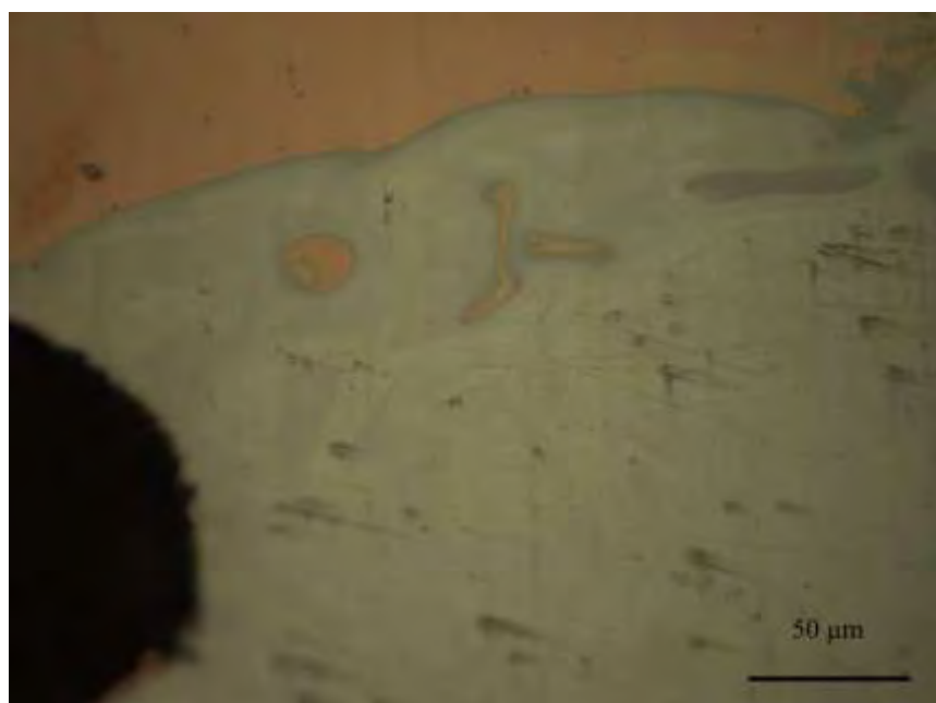
Εικ. 22: Περιοχή συγκόλλησης κατηγορίας B (500x)
