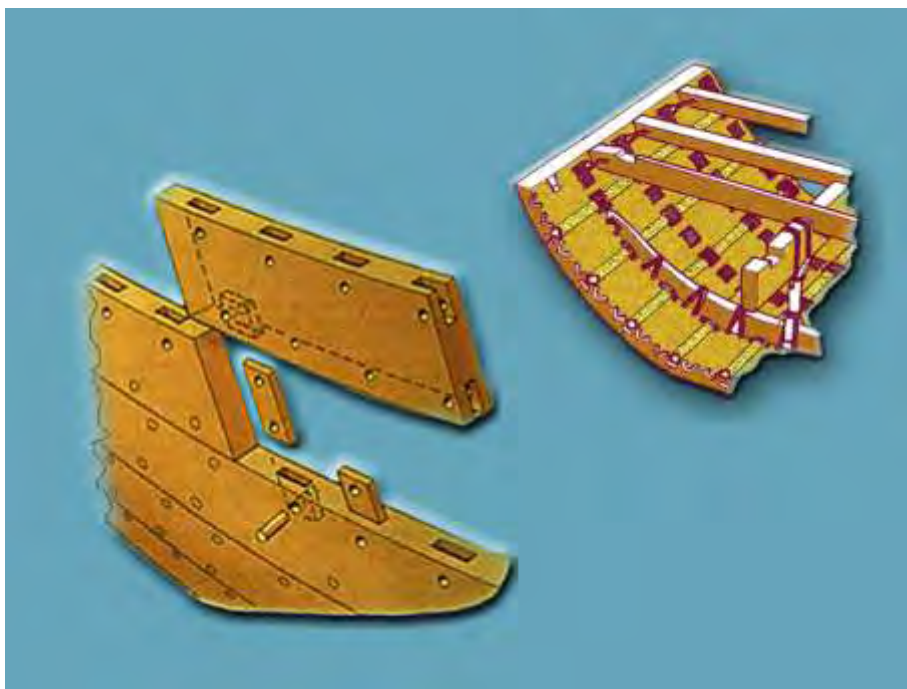
(Εικ. 15) Διάφορα είδη συνδέσεως και πήξεως των ξύλων που χρησιμοποιήθηκαν στην κατασκευή της Αργούς Πηγή: φυλλάδιο «Η αναγέννηση του μυθικού караβιού»
