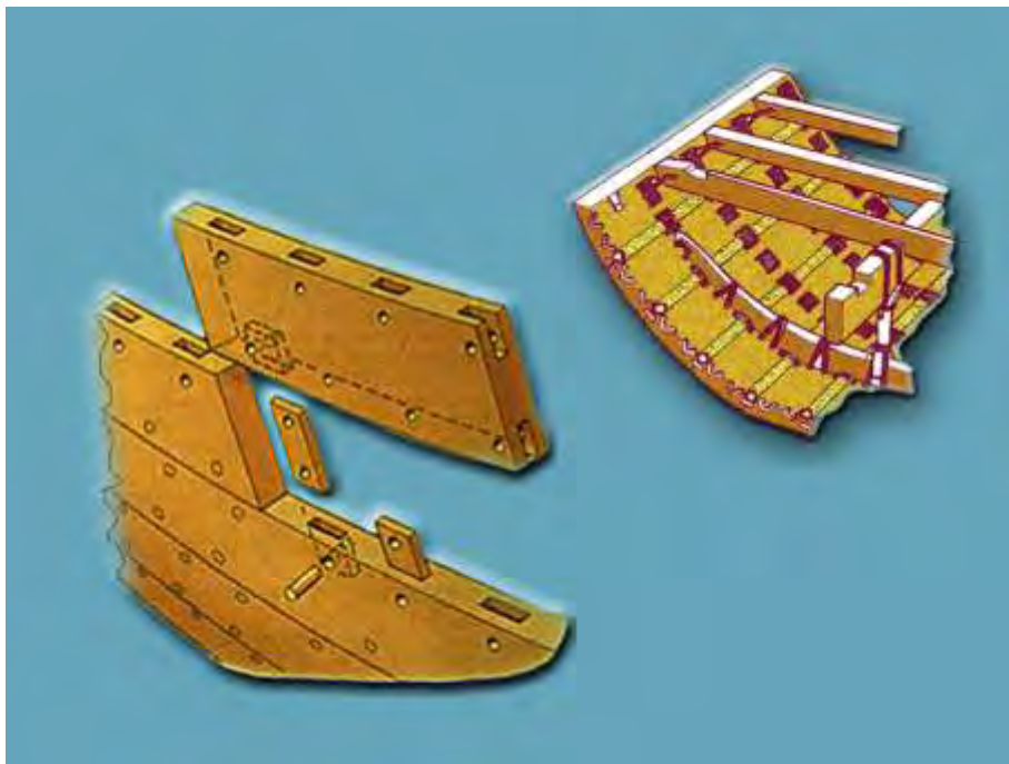
(Εικ. 15) Διάφορα είδη συνδέσεως και πήξεως των ξύλων που χρησιμοποιήθηκαν στην κατασκευή της Αργούς Πηγή: φυλλάδιο «Η αναγέννηση του μυθικού караβιού»
