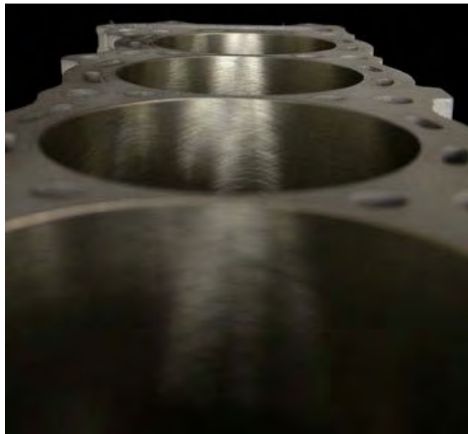
Σχήμα 1.6.10 Αποψη κυλίνδρων τετρακύλινδρης MEK σε σειρά, ορατές οι παράλληλες ελικώσεις που προσδίδουν τα χαρακτηριστικά ανισοτροπίας των επιφανειών των κυλίνδρων.
