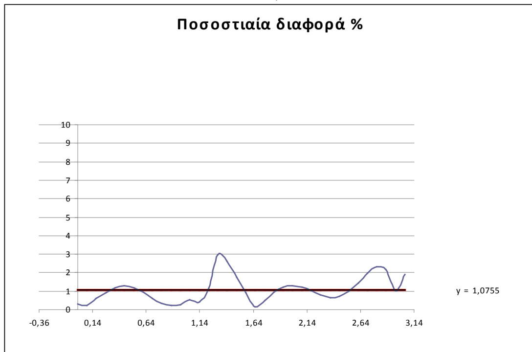
Σχήμα 3.1.7. Σύγκριση καμπύλης για τη συνολική δύναμη τριβής ( f_{tot} ) που υπολογίστηκε με τον πηγαίο κώδικα (κόκκινο) με καμπύλη ταχείας προσέγγισης προερχόμενη από τα διαγράμματα τύπου Stribeck (μπλε) (α). Ακολουθεί το συγκριτικό διάγραμμα ποσοστιαίας διαφοράς μεταξύ των δύο λύσεων (β).
