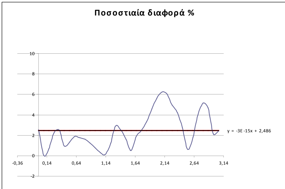
Σχήμα 3.1.3. Σύγκριση καμπύλης για τη συνολική δύναμη τριβής ( f_{tot} ) που υπολογίστηκε με τον πηγαίο κώδικα (κόκκινο) με καμπύλη ταχείας προσέγγισης προερχόμενη από τα διαγράμματα τύπου Stribeck (μπλε) (α). Ακολουθεί το συγκριτικό διάγραμμα ποσοστιαίας διαφοράς μεταξύ των δύο λύσεων (β).
