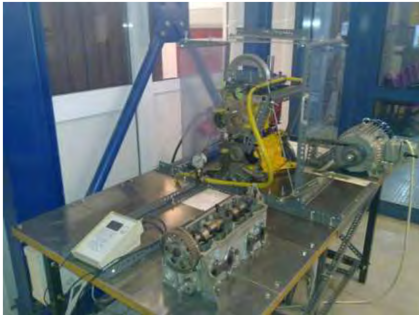
Σχήμα 2.6: Συναρμολογημένο σύνολο μονοκύλινδρου προσομοιωτή δεύτερης γενιάς (Fiat), διακρίνονται το σώμα του κινητήρα, η μετρητική συστοιχία-διάταξη και ο ηλεκτροκινητήρας που κινεί το σύνολο.
