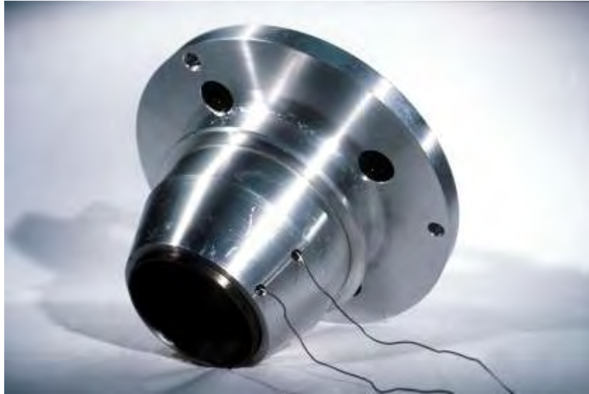
Σχήμα 2.11: Ο «πλωτός» κύλινδρος του προσομοιωτή πρώτης γενιάς αυτός προσαρμόζεται στη μετρητική συστοιχία.
