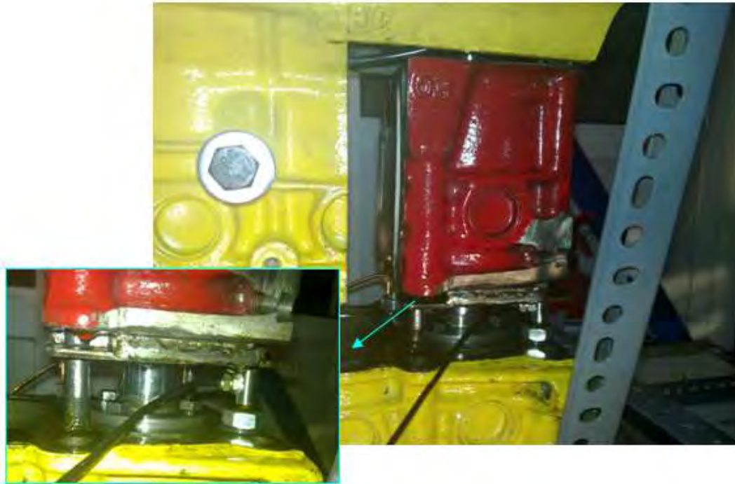
Σχήμα 2.12: Η μετρητική συστοιχία του προσομοιωτή δεύτερης γενιάς.
