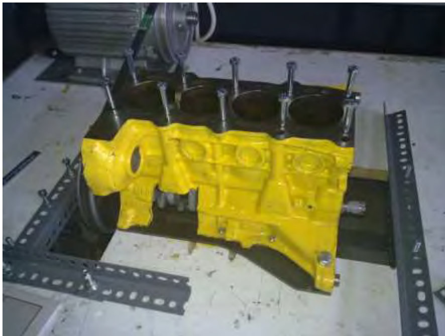
Σχήμα 2.22: Κάτω κινητήρας βάσης και μετάδοση κίνησης από ηλεκτροκινητήρα, μέσω τραπεζοειδών ιμάντων.
