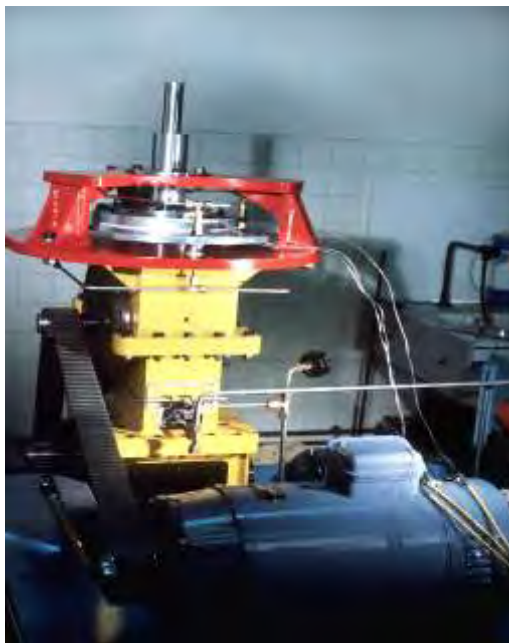
Σχήμα 2.6: Συναρμολογημένο σύνολο μονοκύλινδρου προσομοιωτή δεύτερης γενιάς (Fiat), διακρίνονται το σώμα του κινητήρα, η μετρητική συστοιχία-διάταξη και ο ηλεκτροκινητήρας που κινεί το σύνολο.
