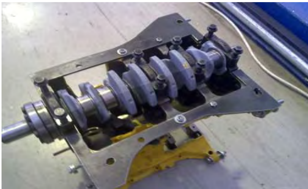
Σχήμα 2.17: Στροφαλοφόρος μονοκύλινδρου προσομοιωτή πρώτης γενιάς, με ειδική κατεργασία για μετάδοση κίνησης από οδοντωτό ιμάντα.
