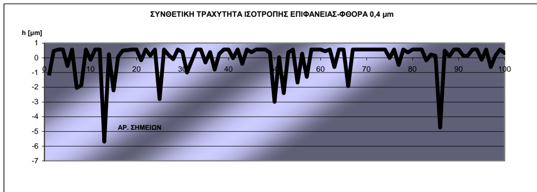
Σχήμα 1.10 Τραχυμέτρηση “στρωμένης” επιφάνειας κυλίνδρου ΜΕΚ (Pandazaras-Renault) (α) και (β) (Pandazaras Π.Θ.) συνθετική ισοδύναμη τραχύτητα του υπολογιστικού κώδικα.
