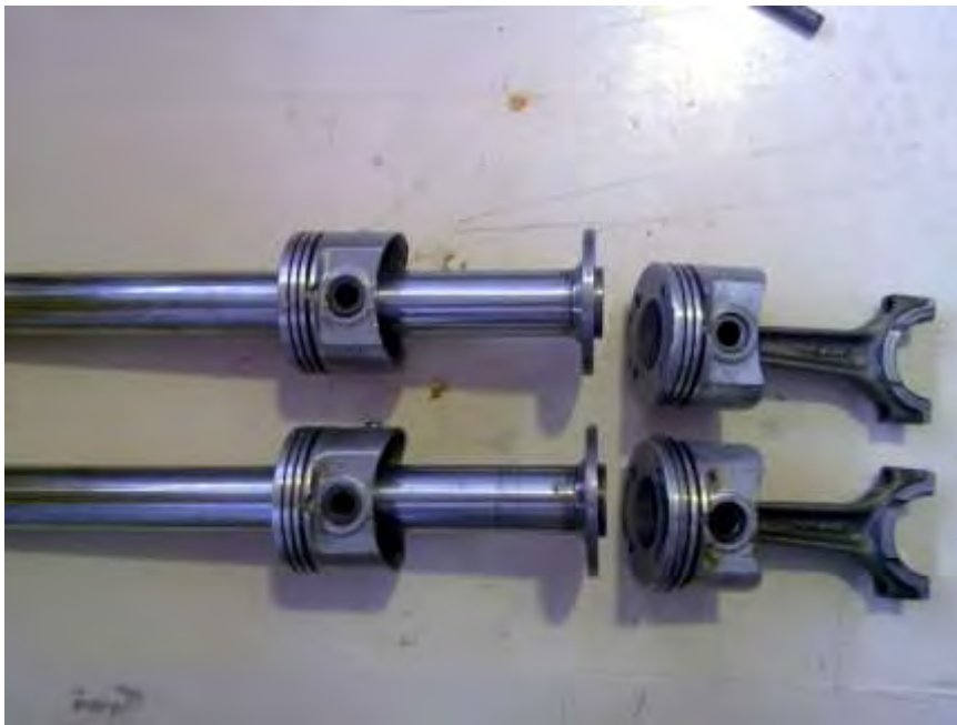
Σχήμα 2.15: Διάταξη οδηγών εμβόλων προσομοιωτή δεύτερης γενιάς
