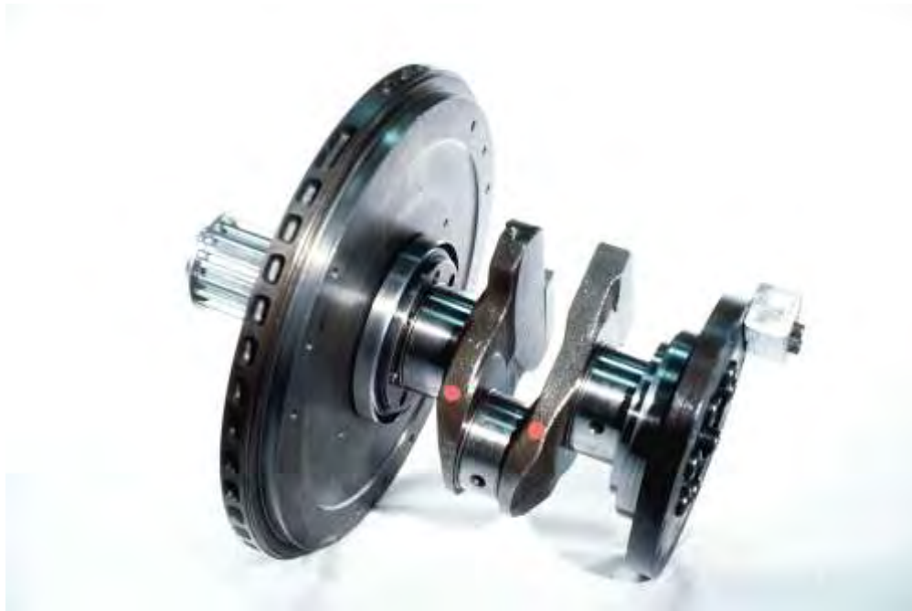
Σχήμα 2.17: Στροφαλοφόρος μονοκύλινδρου προσομοιωτή πρώτης γενιάς, με ειδική κατεργασία για μετάδοση κίνησης από οδοντωτό ιμάντα.
