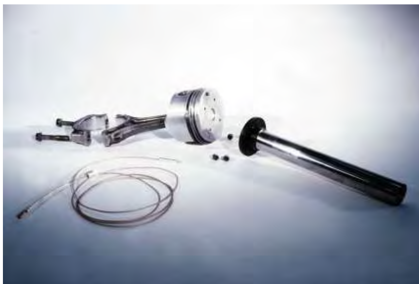
Σχήμα 2.14: Διάταξη οδηγών εμβόλων προσομοιωτή πρώτης γενιάς
