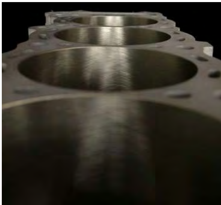
Σχήμα 1.17 Άποψη κυλίνδρων τετρακύλινδρης ΜΕΚ σε σειρά, ορατές οι παράλληλες ελικώσεις που προσδίδουν τα χαρακτηριστικά ανισοτροπίας των επιφανειών των κυλίνδρων. (αρχική τιμή \gamma < 1 , τελική τιμή \gamma > 1 )
