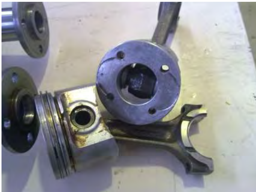
Σχήμα 2.16: Κατεργασμένα έμβολα του κάτω κινητήρα, πάνω στα οποία τοποθετούνται οι οδηγοί εμβόλων. Η σύνδεση γίνεται με διάνοιξη «φωλιάς» στο πάνω μέρος του εμβόλου και συμμετρικά(ανά 90°) ανοιγμένες οπές με σπείρωμα M5.
