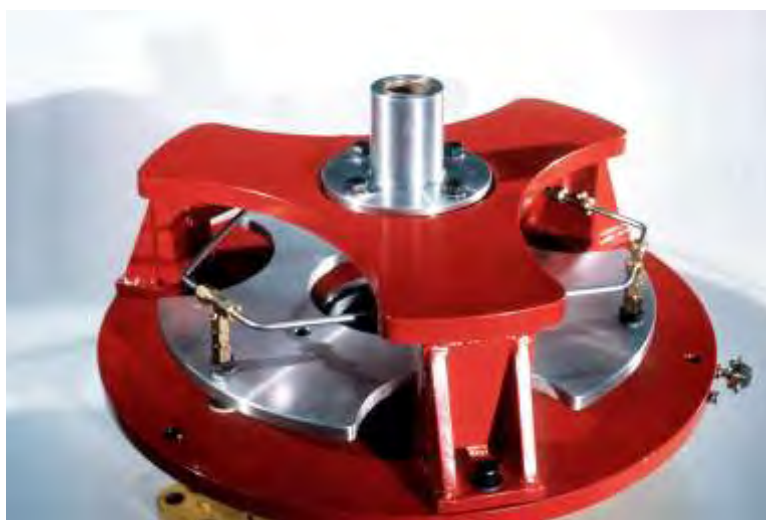
Σχήμα 2.10: Η μετρητική συστοιχία του προσομοιωτή πρώτης γενιάς και το επάνω μέρος οδήγησης του εμβόλου.
