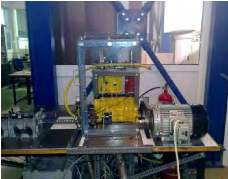
Σχήμα 2.8: Συναρμολογημένο σύνολο προσομοιωτή δεύτερης γενιάς Fiat, διακρίνονται τα σώματα των κινητήρων και ο πλωτός κύλινδρος και ο ηλεκτροκινητήρας (Πανεπιστήμιο Θεσσαλίας).
