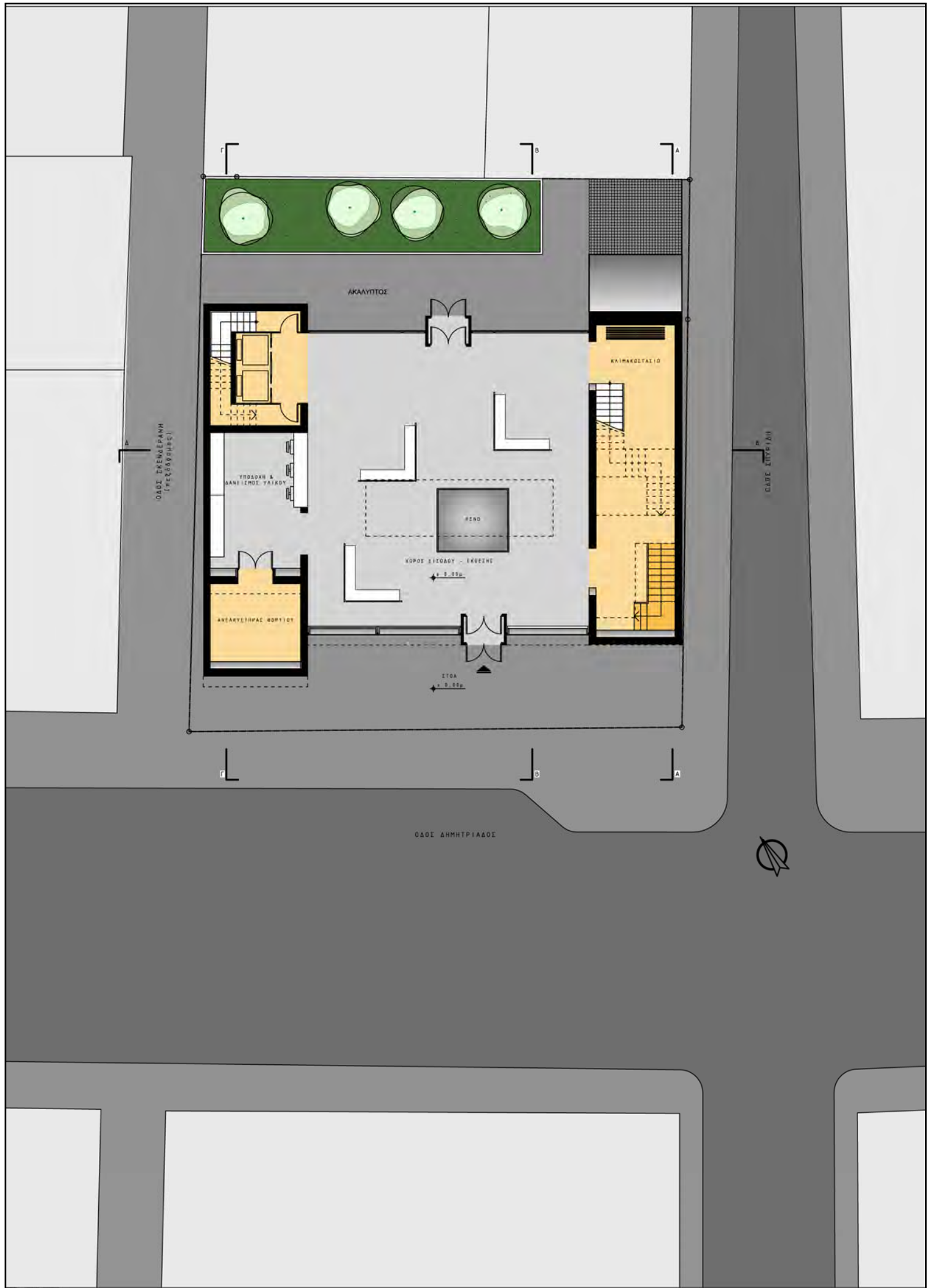
Mediatheque - Πολυμεσική Βιβλιοθήκη στο Βόλο Κάτοψη Ισογείου Κλίμακα 1:200
