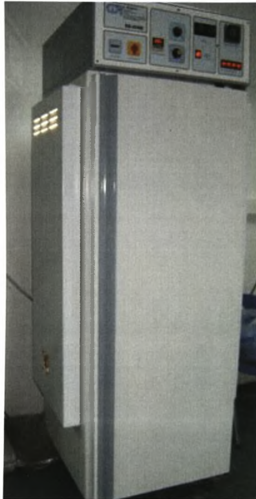
Εικόνα 5. Προβλαστήριο SG-500D στο οποίο πραγματοποιήθηκε η μέτρηση της βλαστικής ικανότητας των σπόρων.
