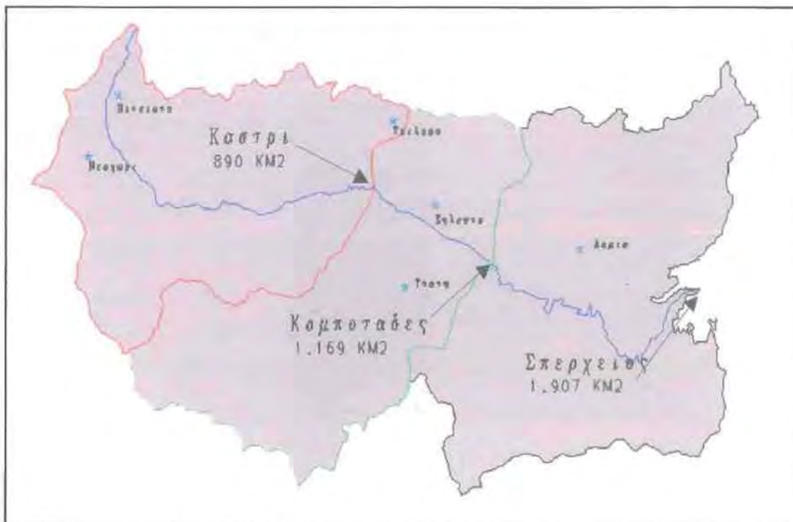
Χάρτης 4.5: Διαίρεση της λεκάνης του Σπερχειού σε υπολεκάνες με βάση τους υδρομετρικούς σταθμούς ανάντη του Καστρίου και των Κομποτάδων (Πηγή: Κουτσογιάννης κ.ά, 1995, σελ 3)
