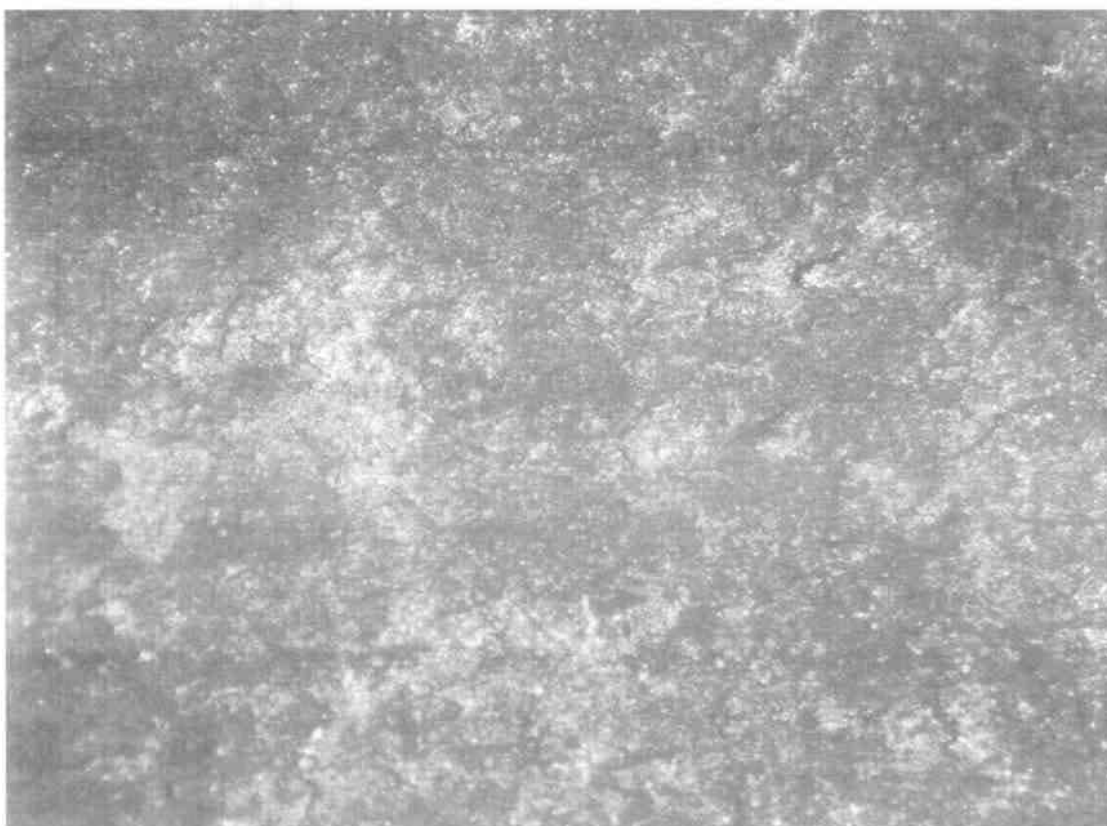
Εικόνα 41 Στερεοσκοπία δοκιμίου 2.2 40x. (διαβρωτικά τρήματα).
