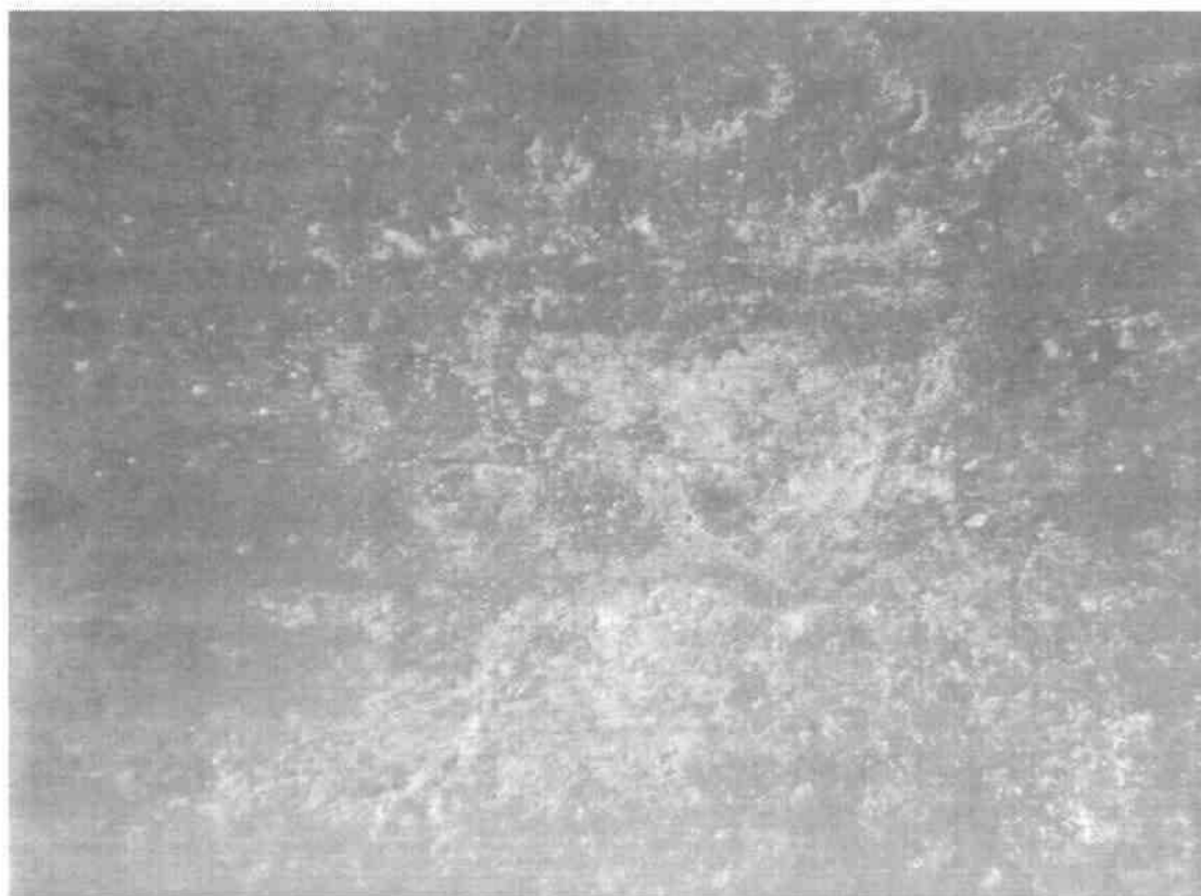
Εικόνα 31 Στερεοσκοπία δοκιμίου 1.5 40x. (διαβρωτικά τρήματα).
