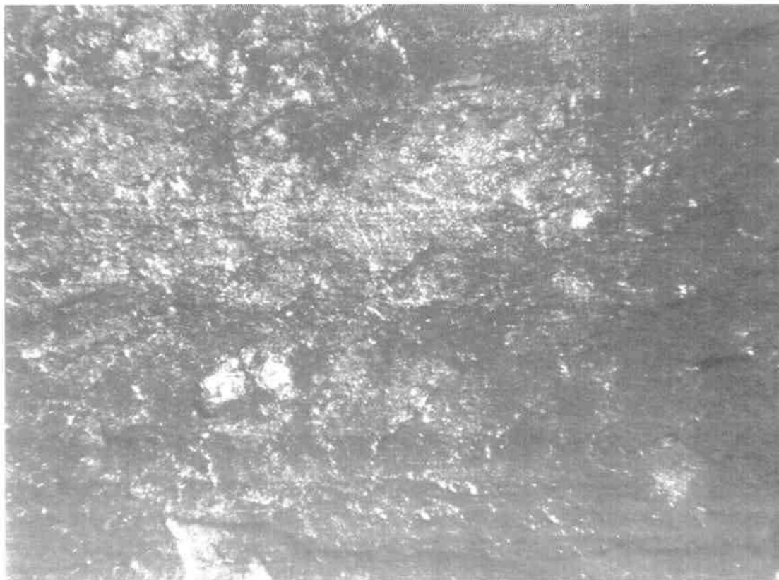
Εικόνα 73 Στερεοσκοπία δοκιμίου 4.1 40x. (Εμφάνιση διαβρωτικών τρημάτων).
