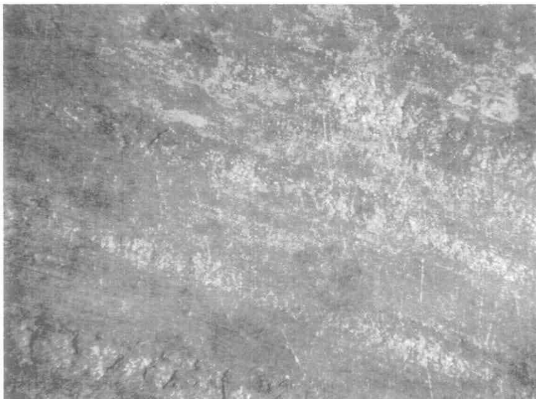
Εικόνα 105 Στερεοσκοπία δοκιμίου 5.5 40x. (Διαβρωτικά τρήματα).
