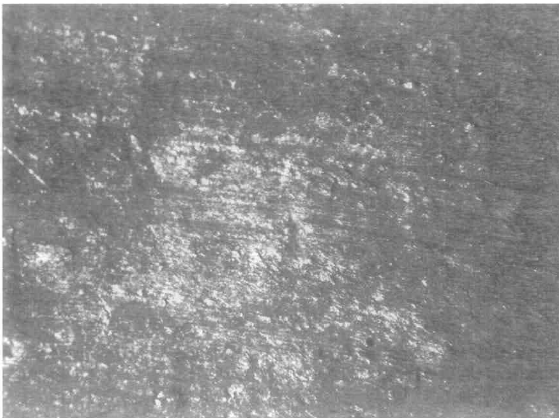
Εικόνα 68 Στερεοσκοπία δοκιμίου 3.6 40x. (Τρηματική διάβρωση).
