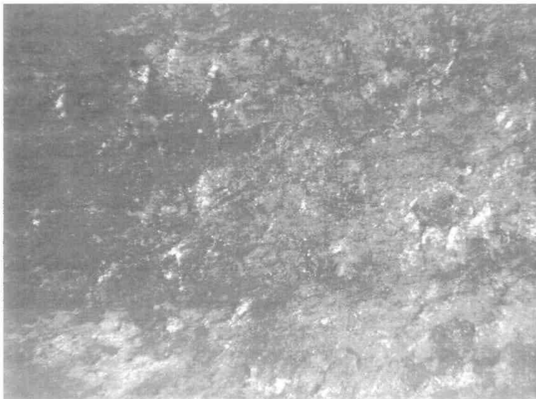
Εικόνα 85 Στερεοσκοπία δοκιμίου 4.5 40x. (Τρηματική διάβρωση).
