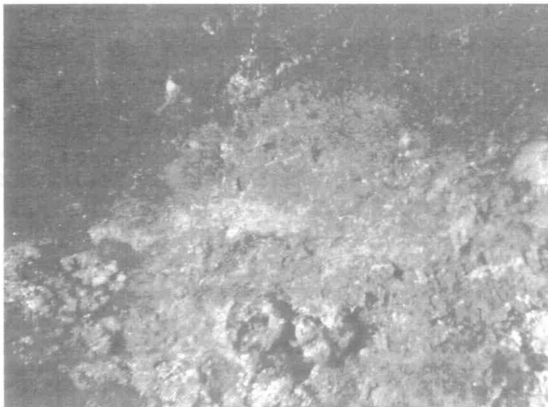
Εικόνα 79 Στερεοσκοπία δοκιμίου 4.3 40x. (Έντονη τρηματοποίηση).
