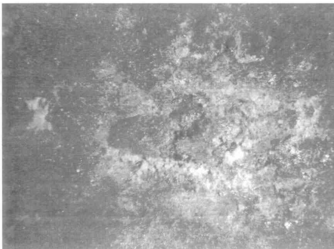
Εικόνα 56 Στερεοσκοπία δοκιμίου 3.2 40x. (Εμφάνιση τρημάτων)
