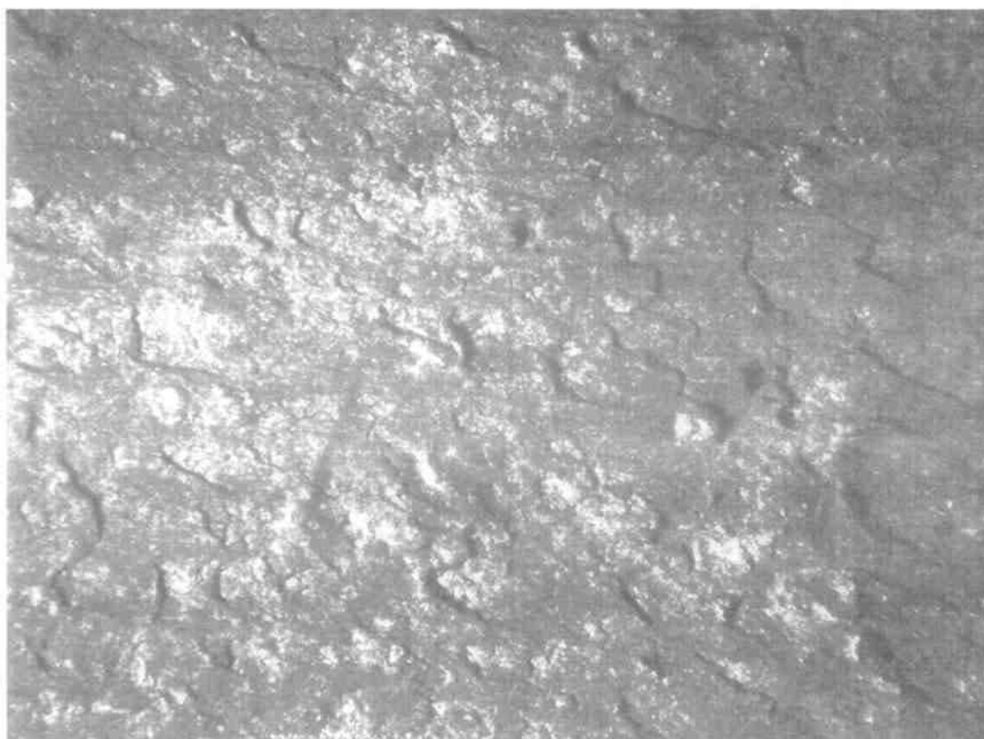
Εικόνα 88 Στερεοσκοπία δοκιμίου 4.6 40x.(Διαβρωτικά τρήματα).
