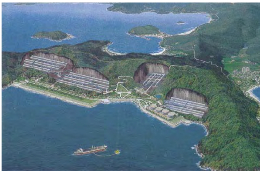
Εικόνα 17: Διάταξη του υπόγειου συγκροτήματος αποθήκευσης αργού πετρελαίου U-2 στην Κορέα (Lee and Song, 2003)
