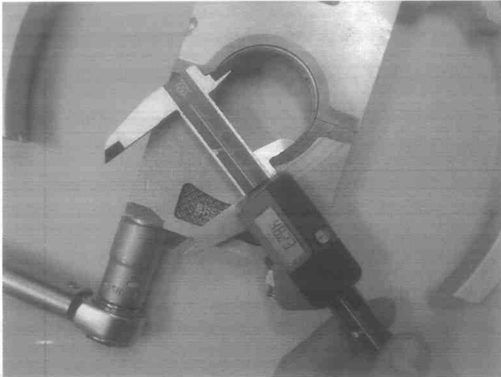
Σχήμα 1.4. Διάμετρος του τριβέα (κουζινέτα πλωτού εδράνου) είναι 48,23\text{mm} . Δηλαδή οι κατασκευαστικές ανοχές είναι (0,5 \text{ έως } 1)/1000 μεταξύ τριβέα και στροφέα.
