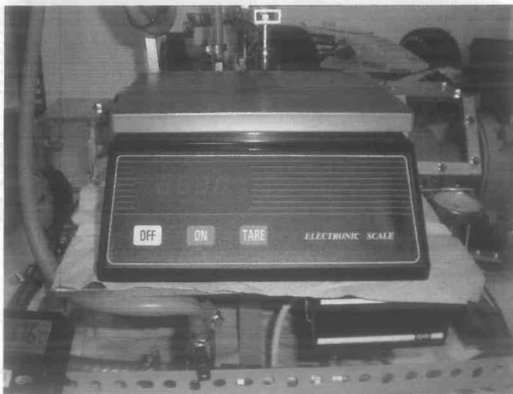
17) Ζυγός ακριβείας-εναλλακτική μέτρηση ροπής τριβής ΕΕΟ
