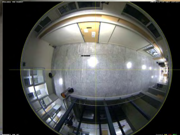
Εικόνα 5: Ένα frame της fisheye κάμερας. Το κέντρο στρέβλωσης (CoD) και η ακτίνα του οπτικού πεδίου έχουν σημειωθεί για να χρησιμοποιηθούν στους μετέπειτα υπολογισμούς
