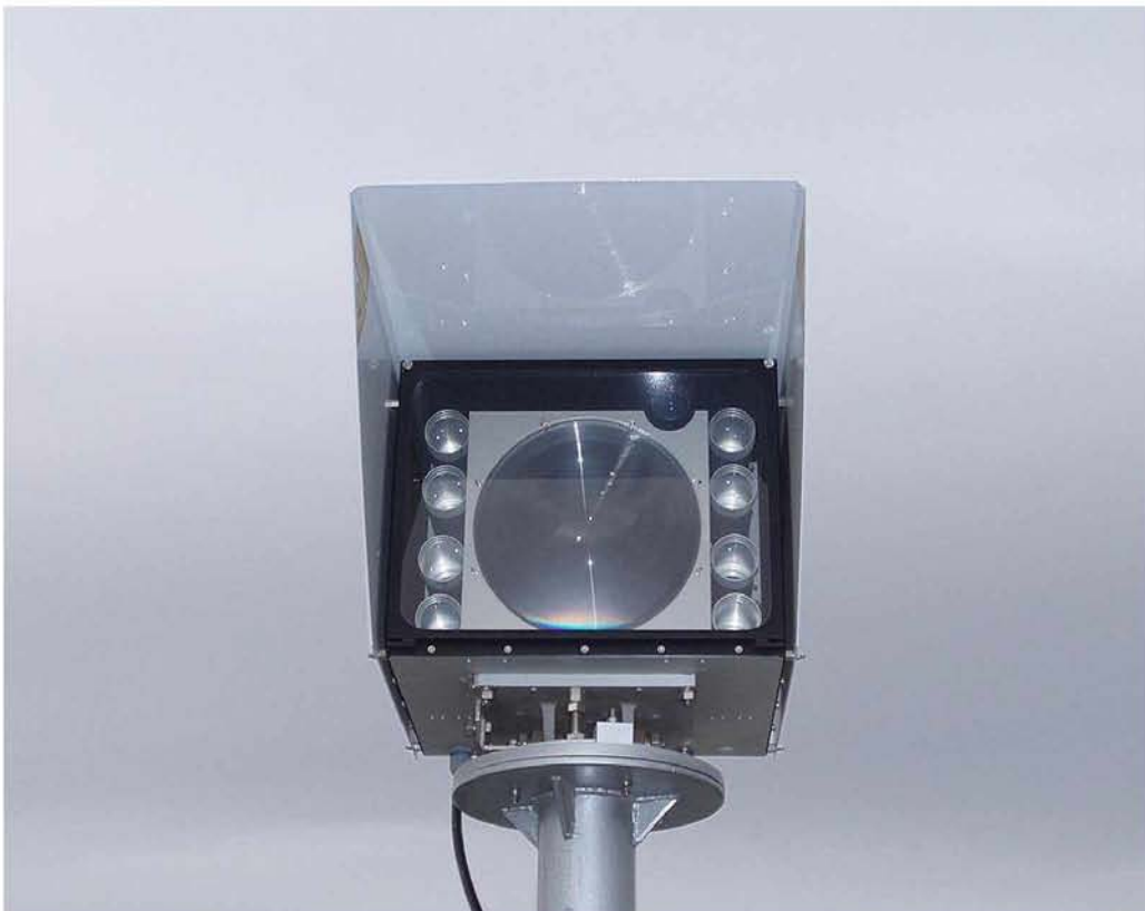
Σχήμα 2.1: Πομποδέκτης FSO ζεύξης(Wikipedia.org/FSO)
