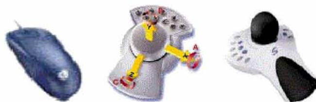
Εικόνα 3 : Τρισδιάστατο ποντίκι - spacemouse (αριστερά & κέντρο) και τρισδιάστατη μπίλια - spaceball (δεξιά).
