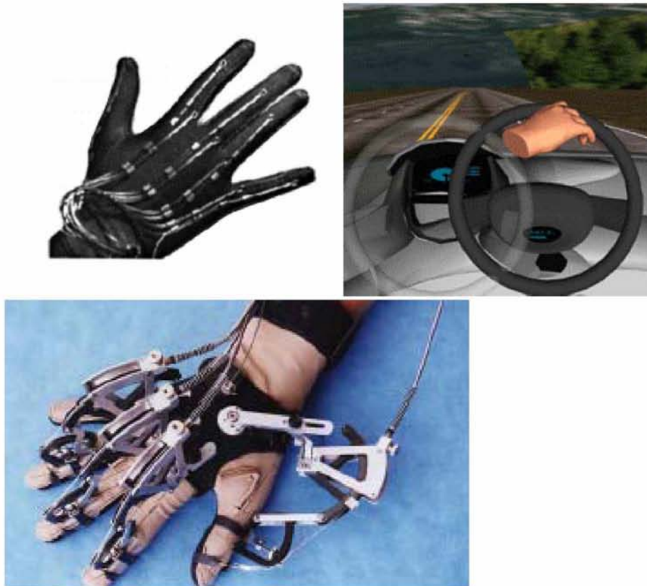
Εικόνα 2 : Γάντι Αίσθησης (Data Glove).
