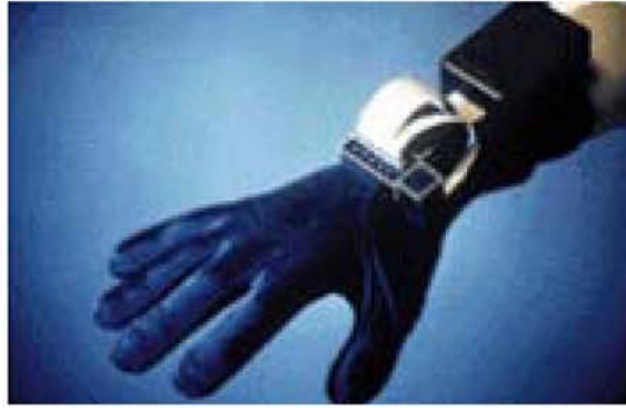
Εικόνα 17 : Χρήση του Γαντιού Δεδομένων για τη μέτρηση των κινήσεων του αθλητή.
