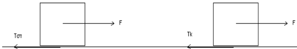
Εικόνα 2.3 Κίνηση σώματος σε επίπεδο λόγω άσκησης δύναμης F και ύπαρξη τριβής T_{στ} και T_k .
