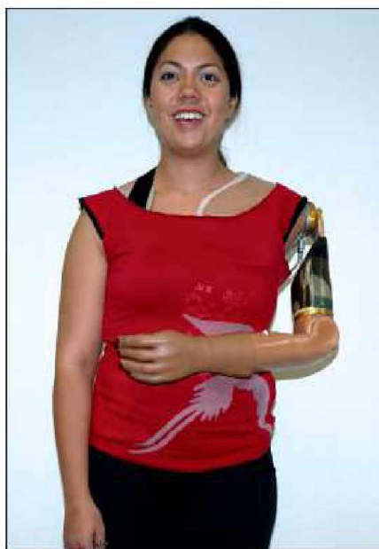
Εικόνα 10. Πειραματική πρόσθεση που αποτελείται από έναν μηχανοποιημένο αγκώνα, καρπό και χέρι με παθητικά τμήματα ώμου.
