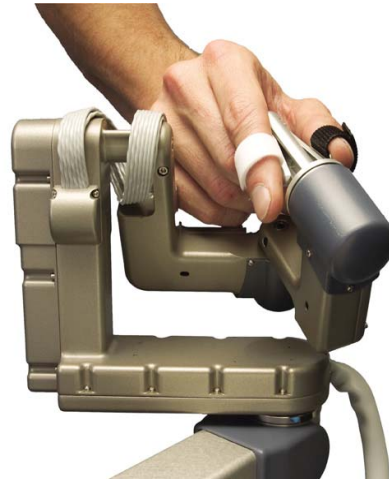
Εικόνα 3.1-3.2. Η κονσόλα του χειρουργού και τα “masters” controls.
