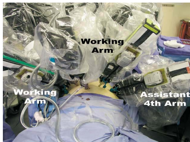
Εικόνα 5.2-5.3. Τα 6 σημεία εισόδου με τις βελόνες παρακέντησης(πάνω) και η εισαγωγή των ρομποτικών βραχιόνων στο σώμα του ασθενή.
