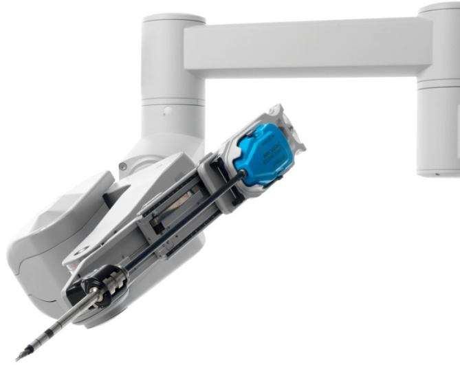
Εικόνα 3.15. Η τοποθέτηση των χειρουργικών εργαλείων στο ρομποτικό βραχίονα
