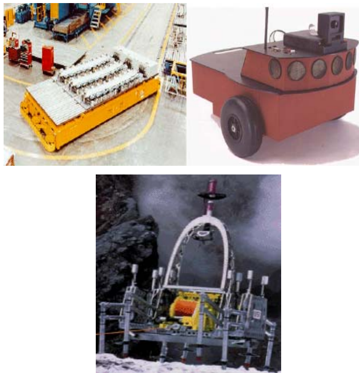
Εικόνα 2.2-2.3-2.4. (Από αριστερά) AGV σε Βιομηχανικό περιβάλλον, Αυτόνομα Έντροχο Ρομπότ και ο Dante II του εργαστηρίου JPL της NASA κατά τη διάρκεια ανάβασης σε βουνό της Αλάσκα
