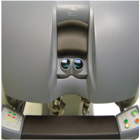
Εικόνα 3.1-3.2. Η κονσόλα του χειρουργού και τα “masters” controls.
