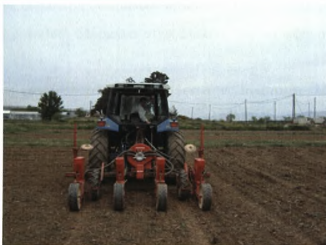
Εικόνα 1.8 Σπορά ηλίανθου με τετράσειρη σπαρτική μηχανή
