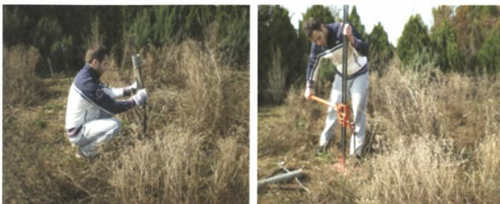
Εικόνα 13: Διάνοιξη οπών για τη τοποθέτηση των αισθητήρων T.D.R. (Time Domain Reflectory) για τη μέτρηση εδαφικής υγρασίας.
