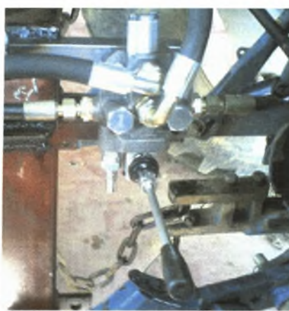
Σχήμα 2.8 Υδραυλική βαλβίδα καθόδου της κατασκευής.
